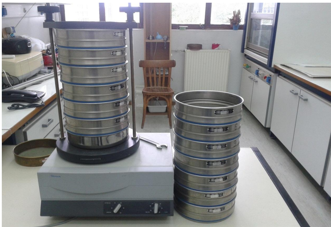
Εικόνα 11. Κόσκινα και δονητής του εργαστηρίου ιζηματολογίας του τμήματος Γεωλογίας Α.Π.Θ.
