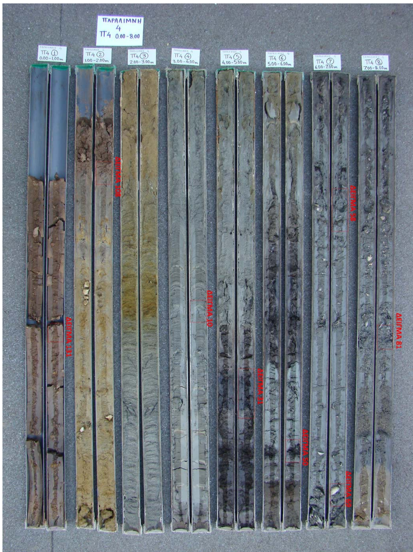
Εικόνα 19: Ενδεικτικές θέσεις τμημάτων πυρήνα που πάρθηκαν για δειγματοληψία σε σχέση με το συνολικό μήκος των καρταριών (Συρίδης, 2008).
