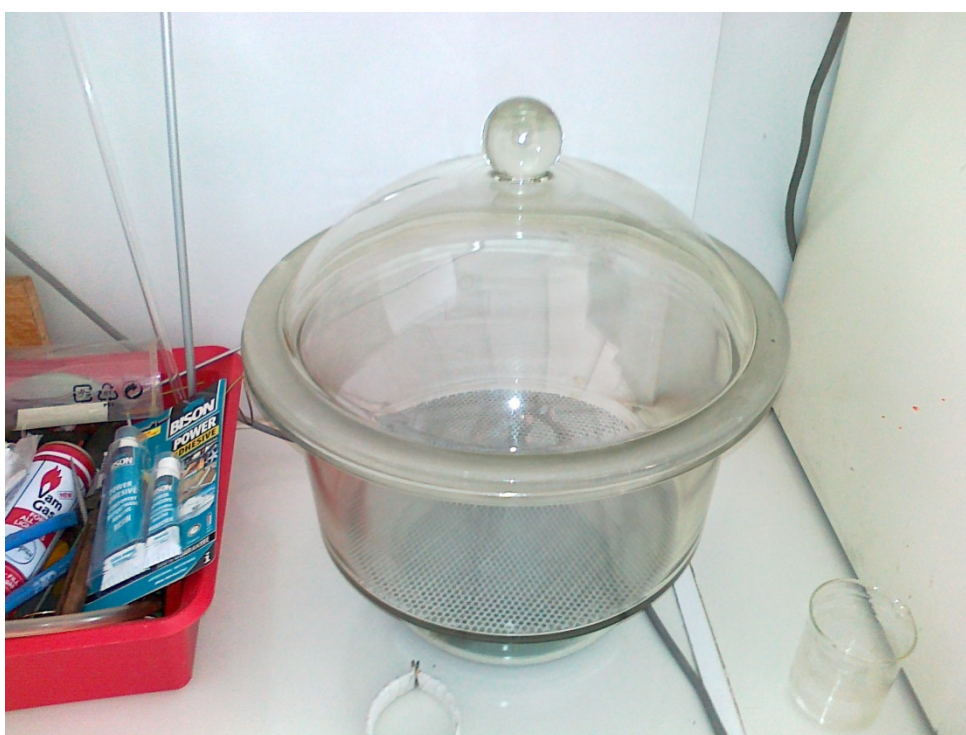
Εικόνα 23: Αφύγρανση δειγμάτων στον αφυγραντήρα
