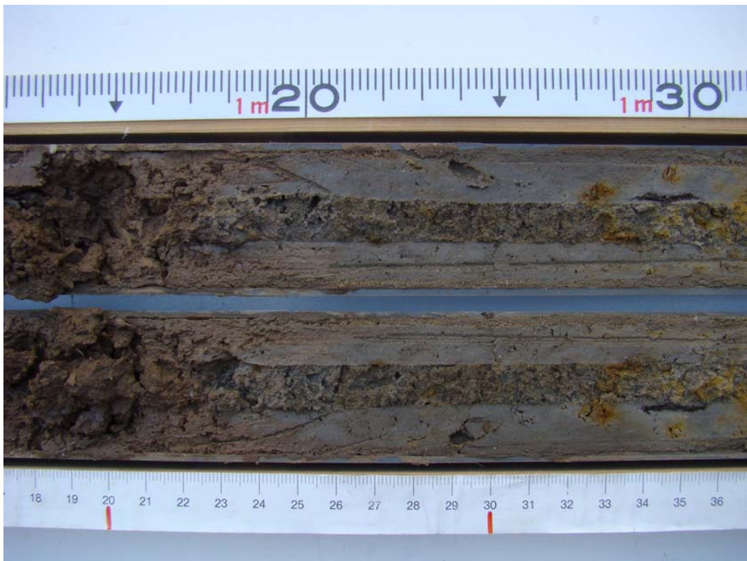
Εικόνα 12: Τμήμα πυρήνα της γεώτρησης (1.15 – 1.20) που αντιστοιχεί στο Δείγμα 108 (Συρίδης, 2008).
