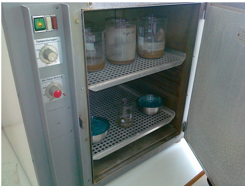
Εικόνα 22: Εξάτμιση δειγμάτων στον εργαστηριακό φούρνο
