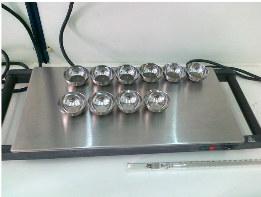
Εικόνα 29: Θέρμανση ειδικών δοχείων στην θερμαινόμενη πλάκα
