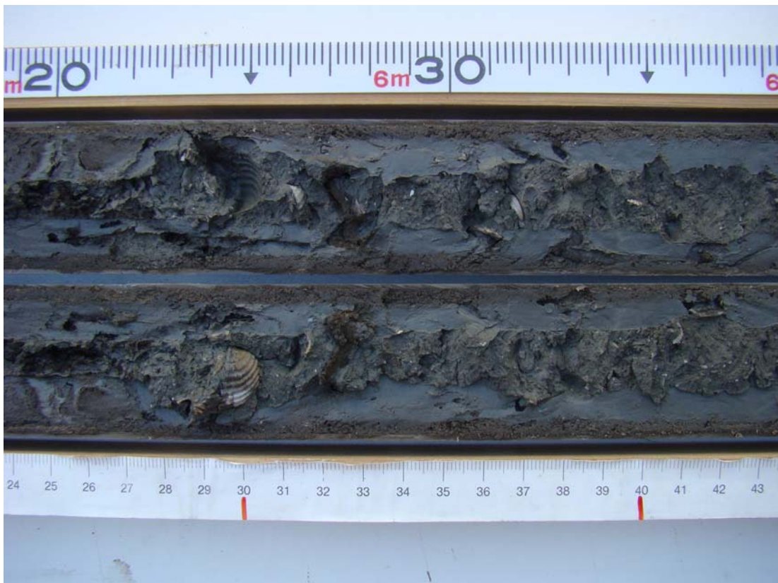
Εικόνα 15: Τμήμα πυρήνα γεώτρησης (5.75 – 5.80) που αντιστοιχεί στο δείγμα 50 (Συρίδης, 2008).
