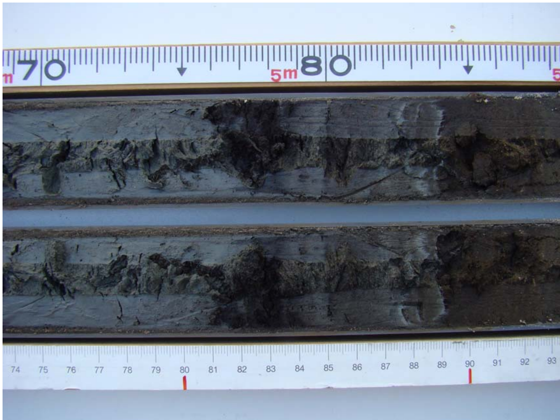
Εικόνα 15: Τμήμα πυρήνα γεώτρησης (5.75 – 5.80) που αντιστοιχεί στο δείγμα 50 (Συρίδης, 2008).
