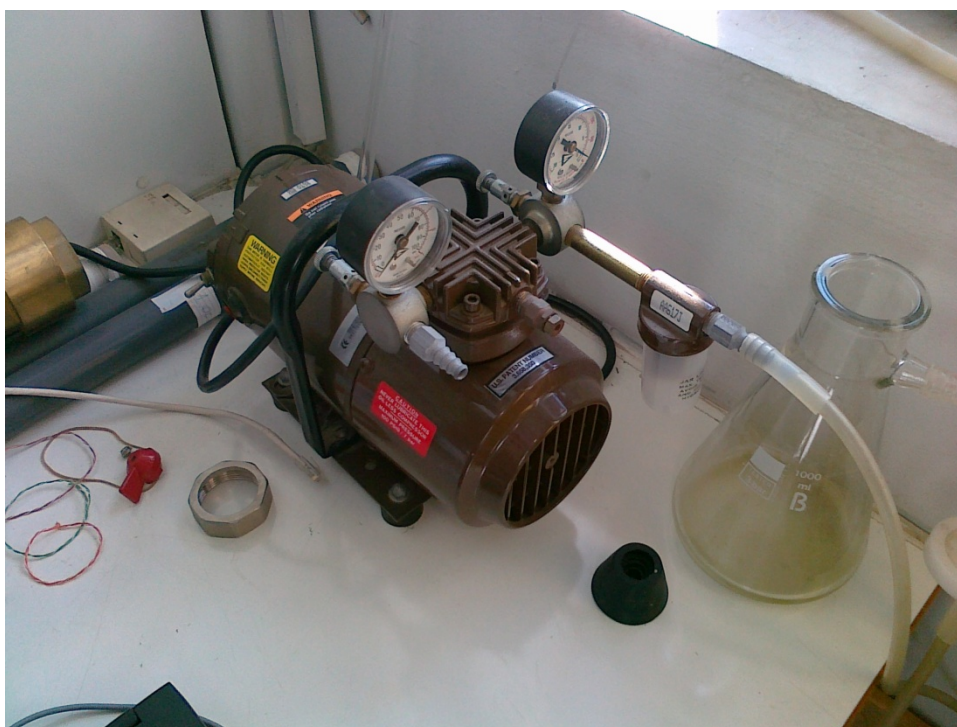
Εικόνα 21: Απορρόφηση νερού μέσω αντλίας
