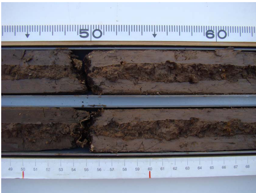
Εικόνα 11: Τμήμα πυρήνα της γεώτρησης (0.55 – 0.60) που αντιστοιχεί στο Δείγμα 131 (Συρίδης, 2008).
