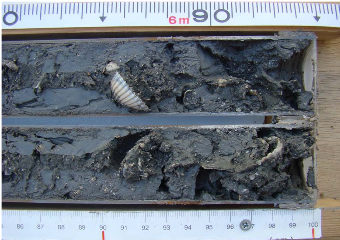
Εικόνα 17: Τμήμα πυρήνα γεώτρησης (6.85 – 6.90) που αντιστοιχεί στο Δείγμα 69 (Συρίδης, 2008).
