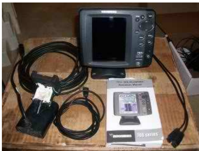
Εικόνα 16: Μονάδα καταγραφής με ενσωματωμένη γεννήτρια παλμών (στα δεξιά) και ένας τύπος πομποδέκτη (στα αριστερά με το καλώδιο). ( http7 )
