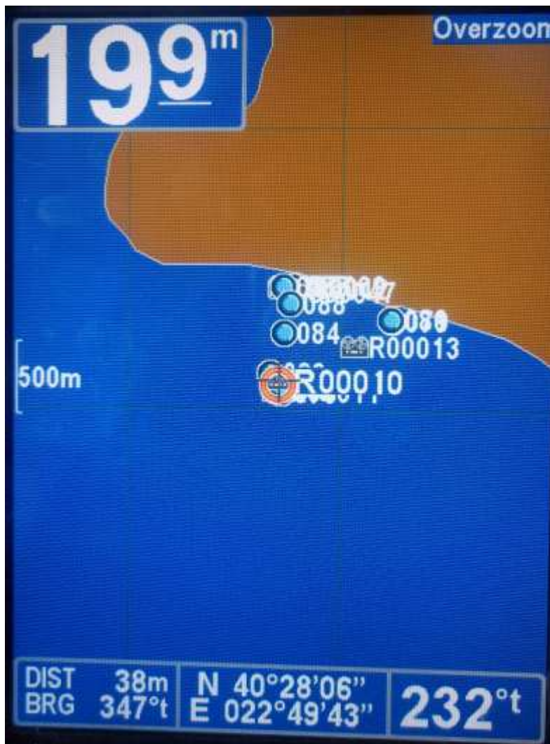
Εικόνα 47: Το σημείο (R000010) απεικονίζει το σημείο διάχυσης του αγωγού λυμάτων. Όπως παρατηρούμε στην πάνω αριστερά γωνία της φωτογραφίας, το βάθος είναι 19.9m ≈ 20m.
