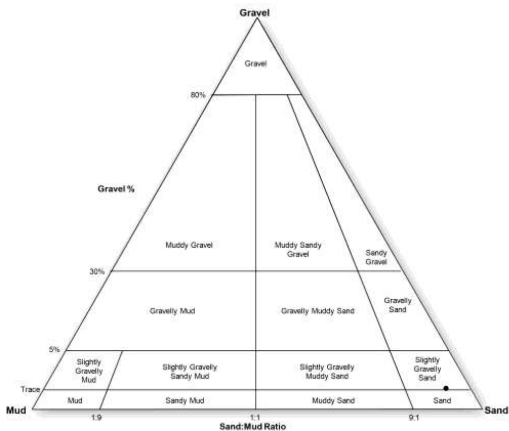
Σχήμα 1.66: χαλικιών, ιλύος, άμμου όπου το δείγμα 10Λ είναι ελαφρός χαλικώδης άμμος
