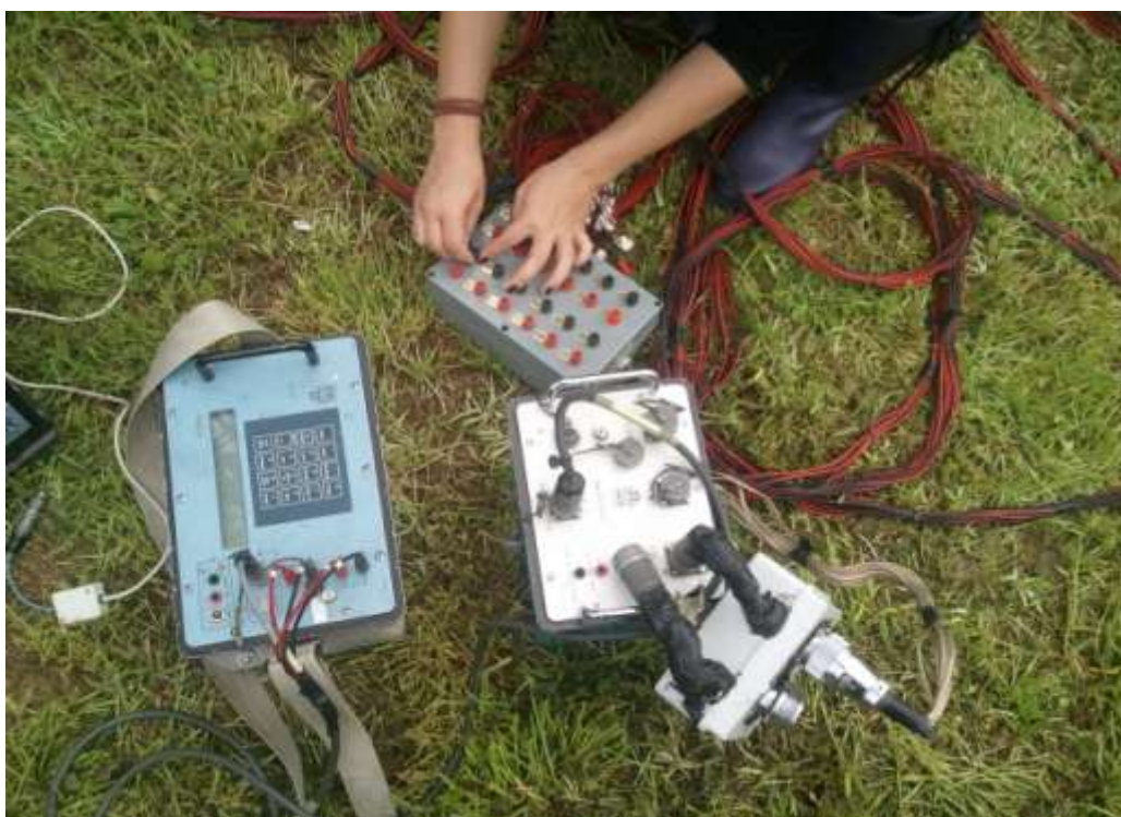
Φωτογραφία 4.3 : α) Syscal Pro (Τσουρλος, 2009), β) συνδεσμολογία του Syscal με το πολυκάναλο καλώδιο.
