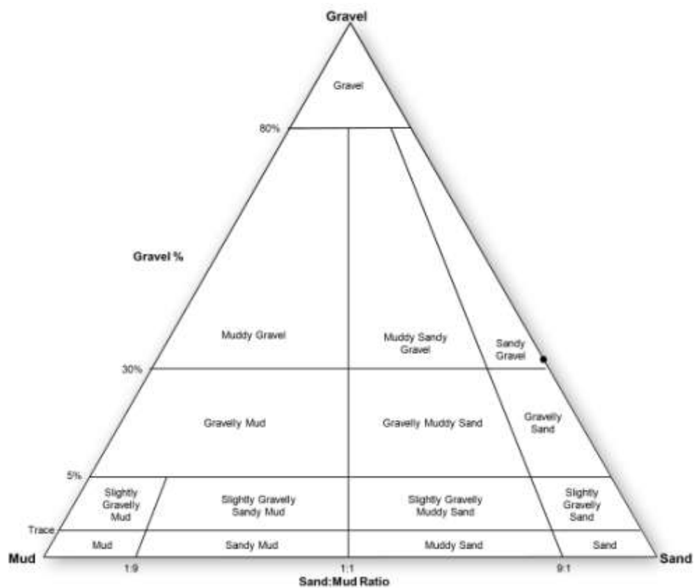
Σχήμα Ι.21: χαλικιών, ιλύος, άμμου όπου το δείγμα 7Π είναι αμμούχος χάλικας
