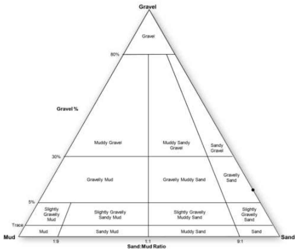
Σχήμα 1.24: χαλικιών, ιλύος, άμμου όπου το δείγμα 8Π είναι χαλικώδης άμμος
