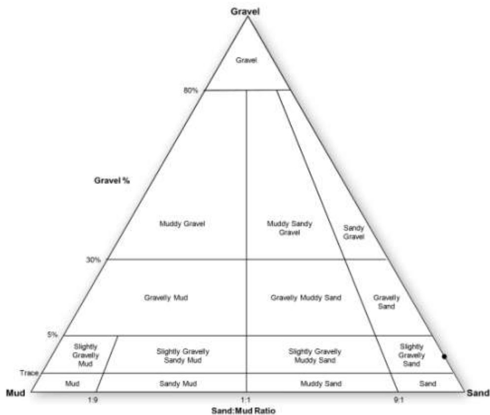
Σχήμα 1.6: χαλικιών, ιλύος, άμμου όπου το δείγμα 2Π είναι ελαφρός χαλικώδης άμμος
