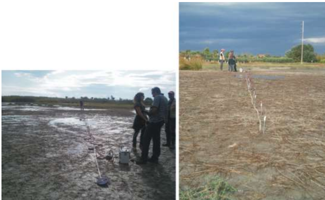
Φωτογραφία 4.4: ηλεκτρική τομογραφία, με απόσταση ηλεκτροδίων 1m.
