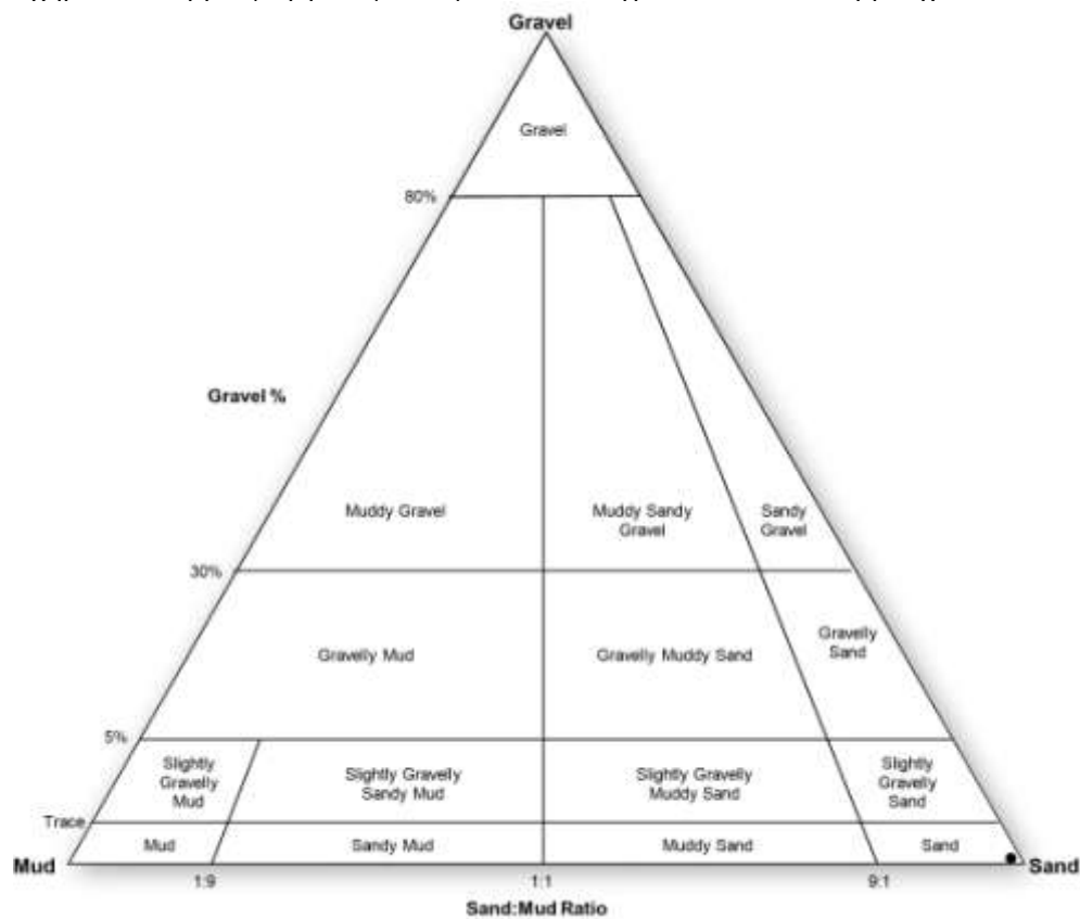
Σχήμα Ι.42: χαλικιών, ιλύος, άμμου όπου το δείγμα 17 ΖΕ είναι αμμούχο
