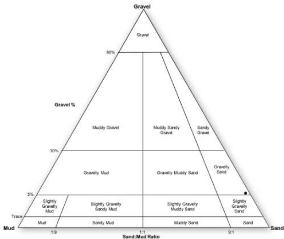
Σχήμα Ι.48: χαλικιών, ιλύος, άμμου όπου το δείγμα 19 ΖΕ είναι χαλικώδης άμμος
