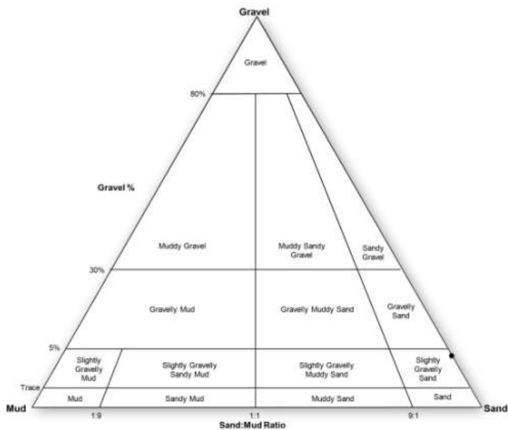
Σχήμα 1.54: χαλικιών, ιλύος, άμμου όπου το δείγμα 21 ΖΕ είναι ελαφρός χαλικώδης άμμος
