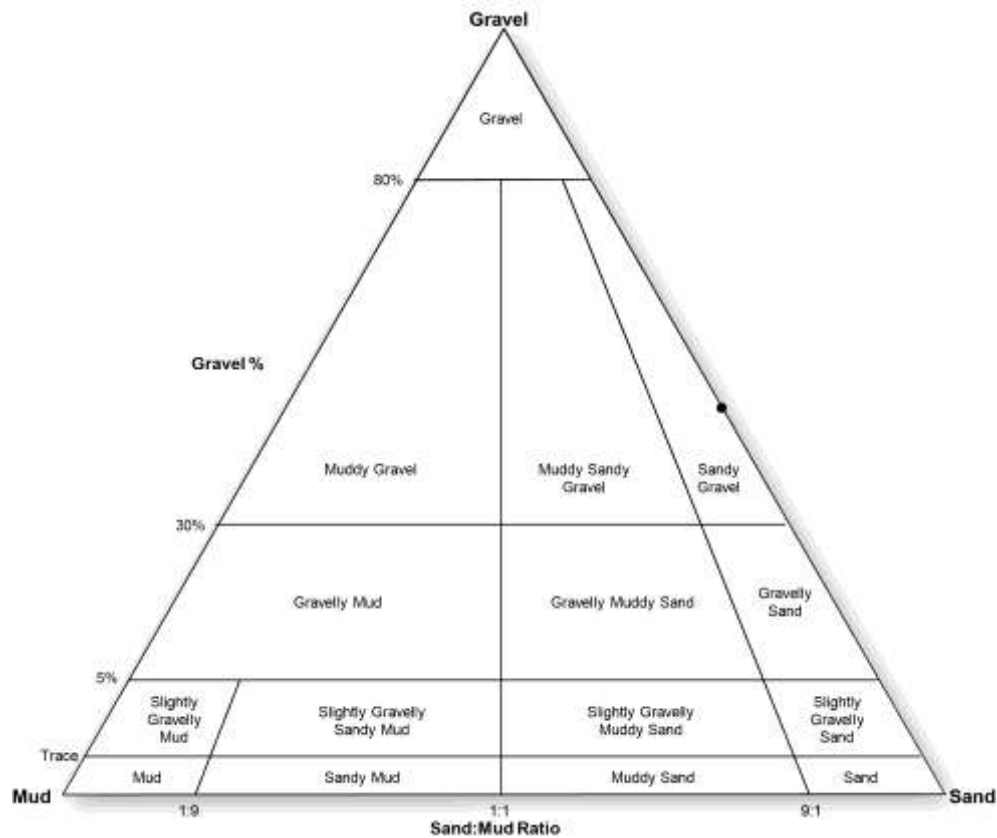
Σχήμα 1.27: χαλικιών, ιλύος, άμμου όπου το δείγμα 9Π είναι αμμούχα χαλίκια
