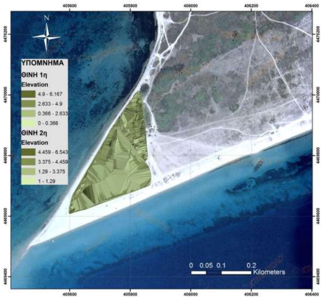
Σχήμα 6.5 : Χαρτογράφηση των θινών στη μύτη του ακρωτηρίου. Στο υπόμνημα φαίνονται τα υψόμετρα των θινών.
