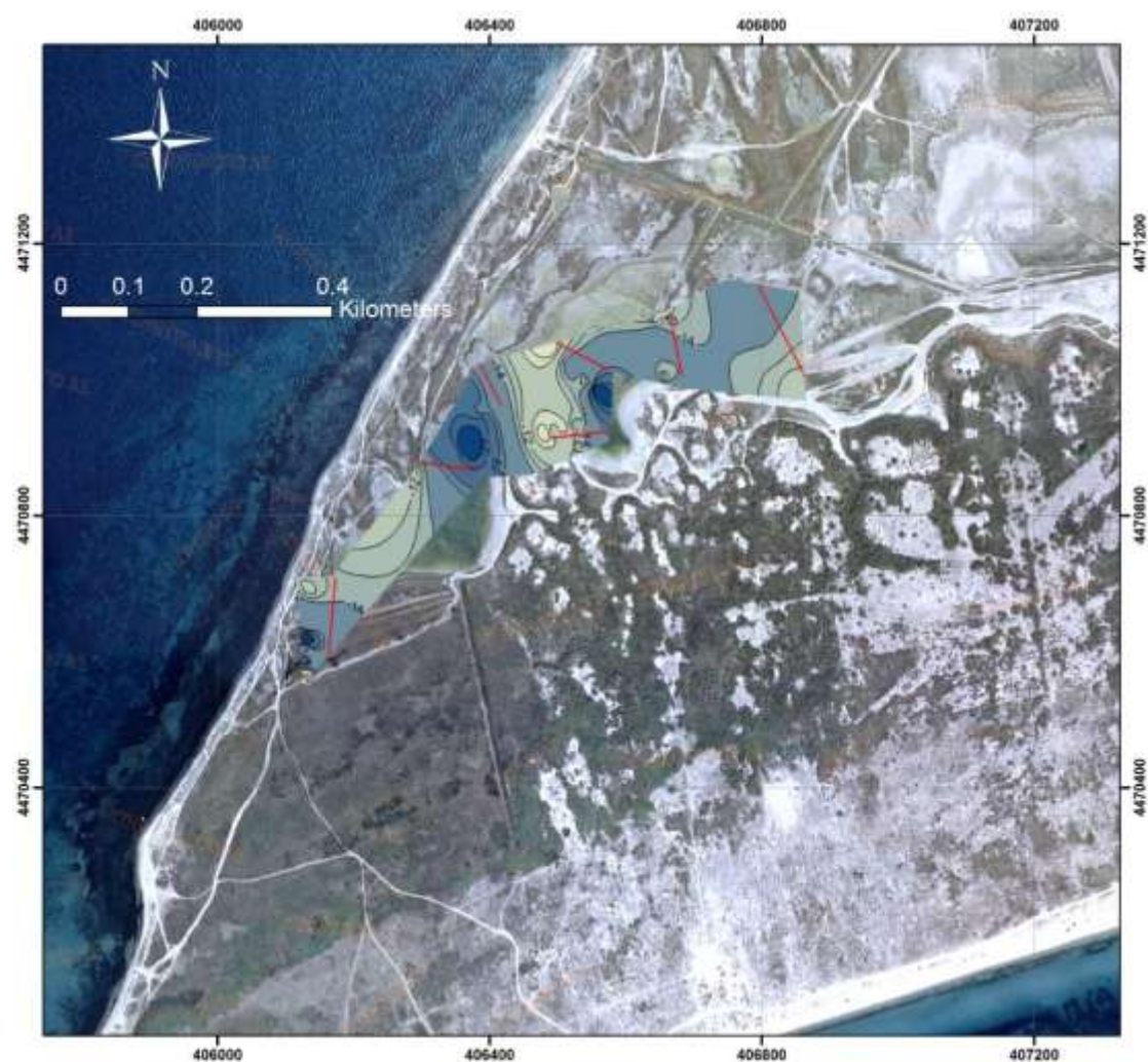
Σχήμα 7.26 : Γεωαναφερμένη απεικόνιση του χάρτη των ισηλεκτρικών αντιστάσεων 1,2 στην περιοχή μελέτης.
