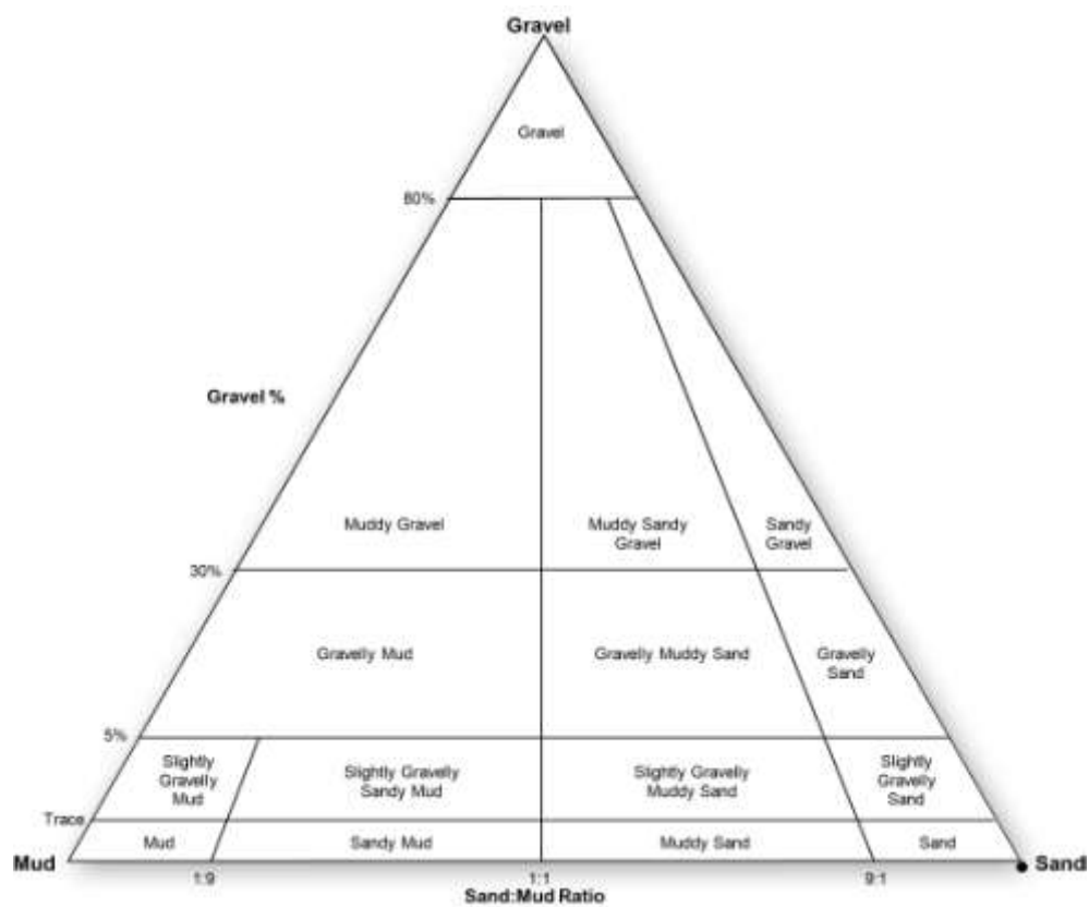
Σχήμα Ι.33: χαλικιών, ιλός, άμμου όπου το δείγμα 2Θ είναι αμμούχο
