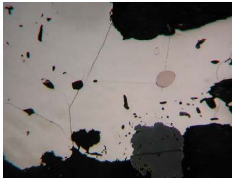
Εικόνα 10 : Σιδηροπυρίτης με εγκλείσματα χαλκοπυρίτη και μιλλερίτη
