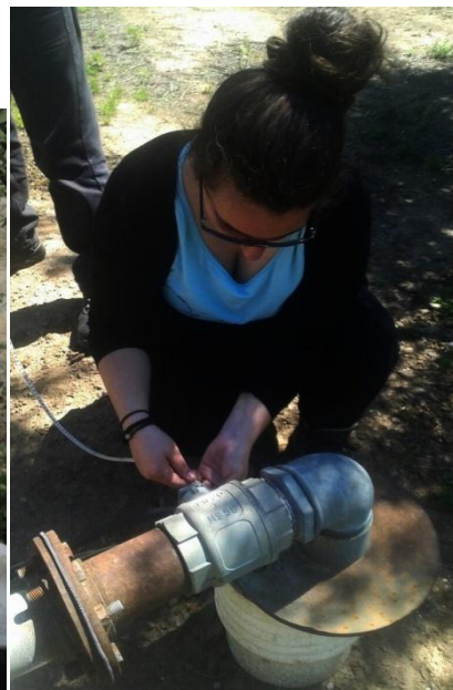
Σχήμα 14: Μέτρηση στάθμης υπόγειου νερού με τη χρήση σταθμημέτρου
