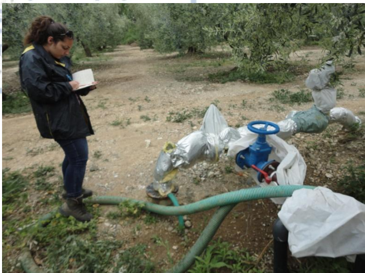
Σχήμα 14: Μέτρηση στάθμης υπόγειου νερού με τη χρήση σταθμημέτρου
