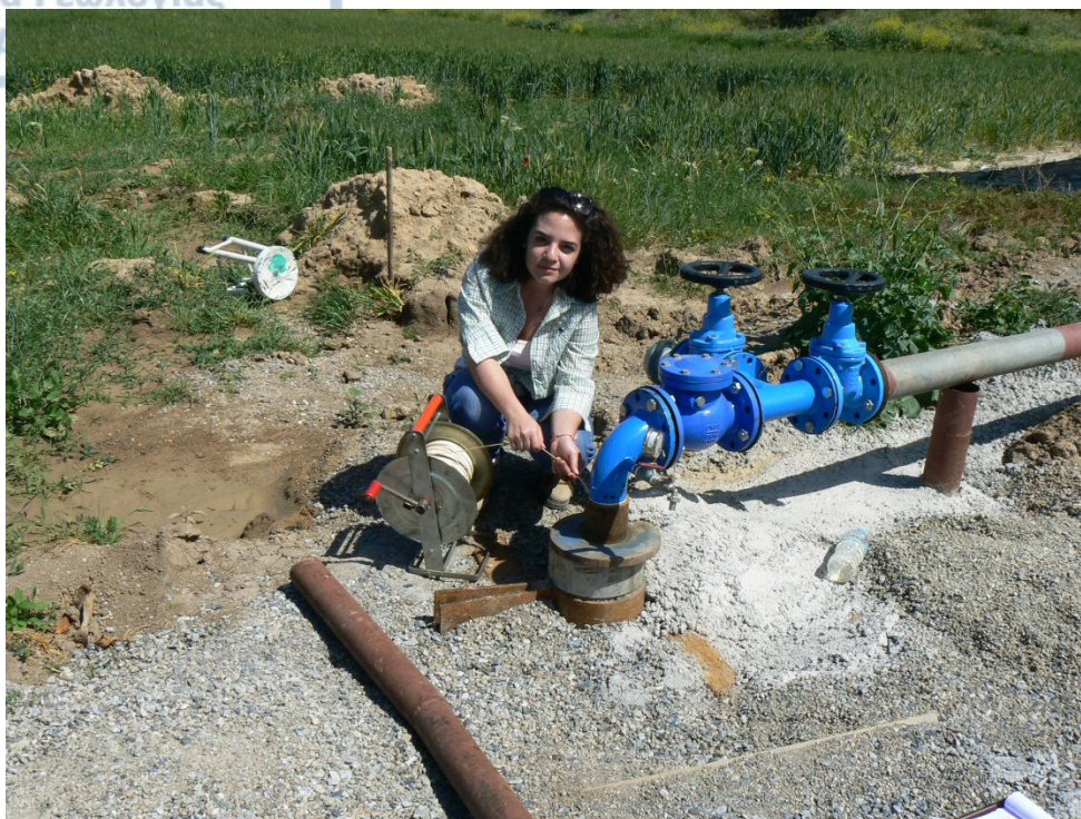
Σχήμα Π.1 Μέτρηση της στάθμης του υπόγειου νερού στη γεώτρηση MR42.
