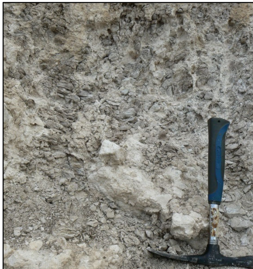
Σχήμα 3.6 Ψαμμιτομαργαϊκή σειρά με εναλλαγές στρωμάτων αργίλου και αργιλούχας μάργας (πάνω), τμήμα του στρώματος αργιλούχας μάργας της ψαμμιτομαργαϊκής σειράς (κάτω).
