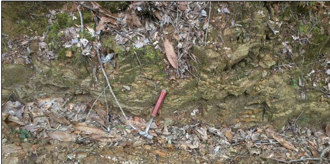
Εικόνα 38. Σχιστοποιημένος γνεύσιος με ίχνη υγρασίας στη θέση παρατήρησης 2
