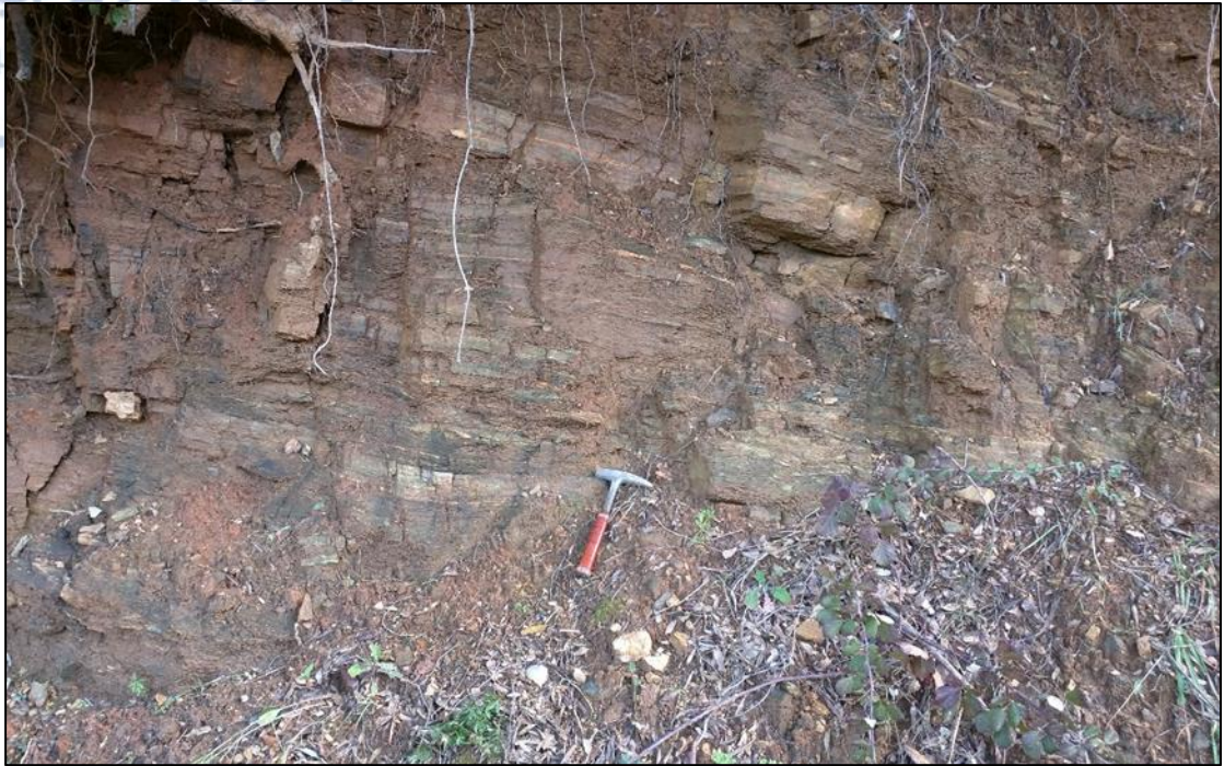
Εικόνα 23. Χαρακτηριστική εικόνα της σχιστότητας των πετρωμάτων με μικρές γωνίες κλίσης
