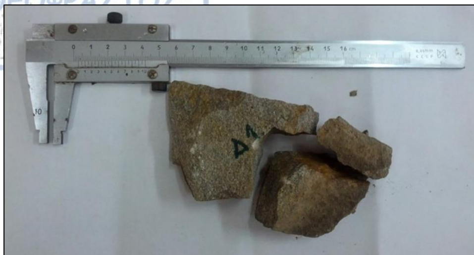
Εικόνα 67. Δοκιμή σημειακής φόρτισης σε δείγμα γνευσίου (Δ1)
