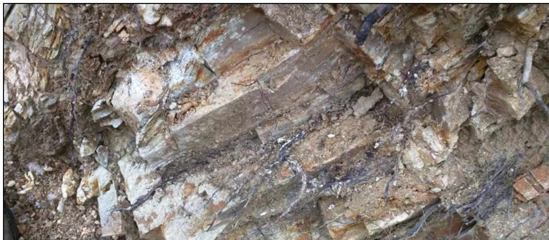
Εικόνα 56. Κατακερματισμός των γενεσίων από τις ρίζες μέσω των συστημάτων διακλάσεων στη θέση παρατήρησης 19
