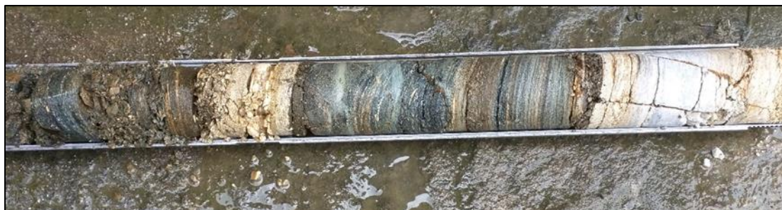
Εικόνα 18. Χαρακτηριστική εικόνα του υποβάθρου με τους γενυσίους της περιοχής να εναλλάσσονται με απλιτικές φλέβες και χαλαζιακές διεισδύσεις
