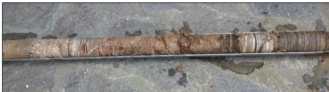
Εικόνα 17. Ενδεικτική εικόνα των γνευσίων (gn 2 ) στην περιοχή έρευνας με εναλλαγές υγείων και αποσαθρωμένων ζωνών κατά μήκος της σχιστότητας.
