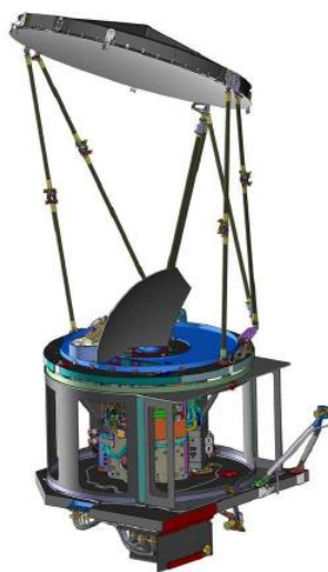
Εικόνα 2.6 - Το μικροκυματικό ραδιόμετρο GMI του δορυφόρου GPM. (Πηγή: JAXA)
