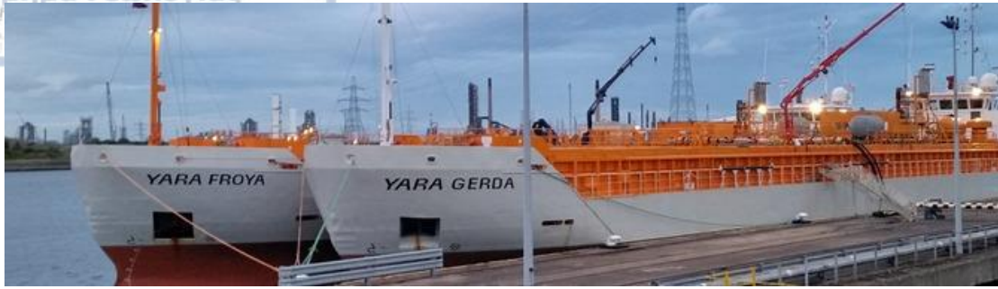
Εικόνα 4.3 : Πλοία ειδικά κατασκευασμένα για τη μεταφορά CO 2 ( https://www.green4sea.com/new-liquid-co2-ship-for-yara ).
