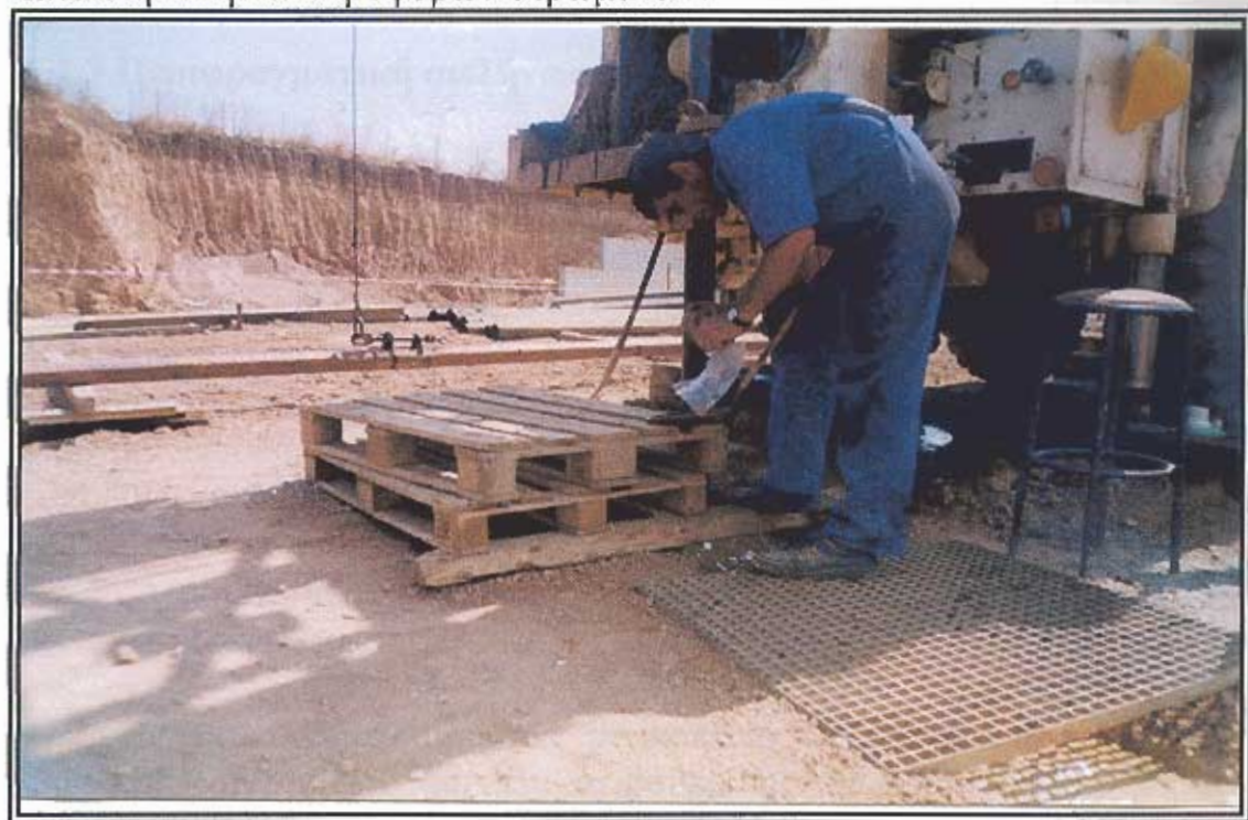
Εικόνα 16 .Δειγματοληψία με κατάλληλη σήτα
