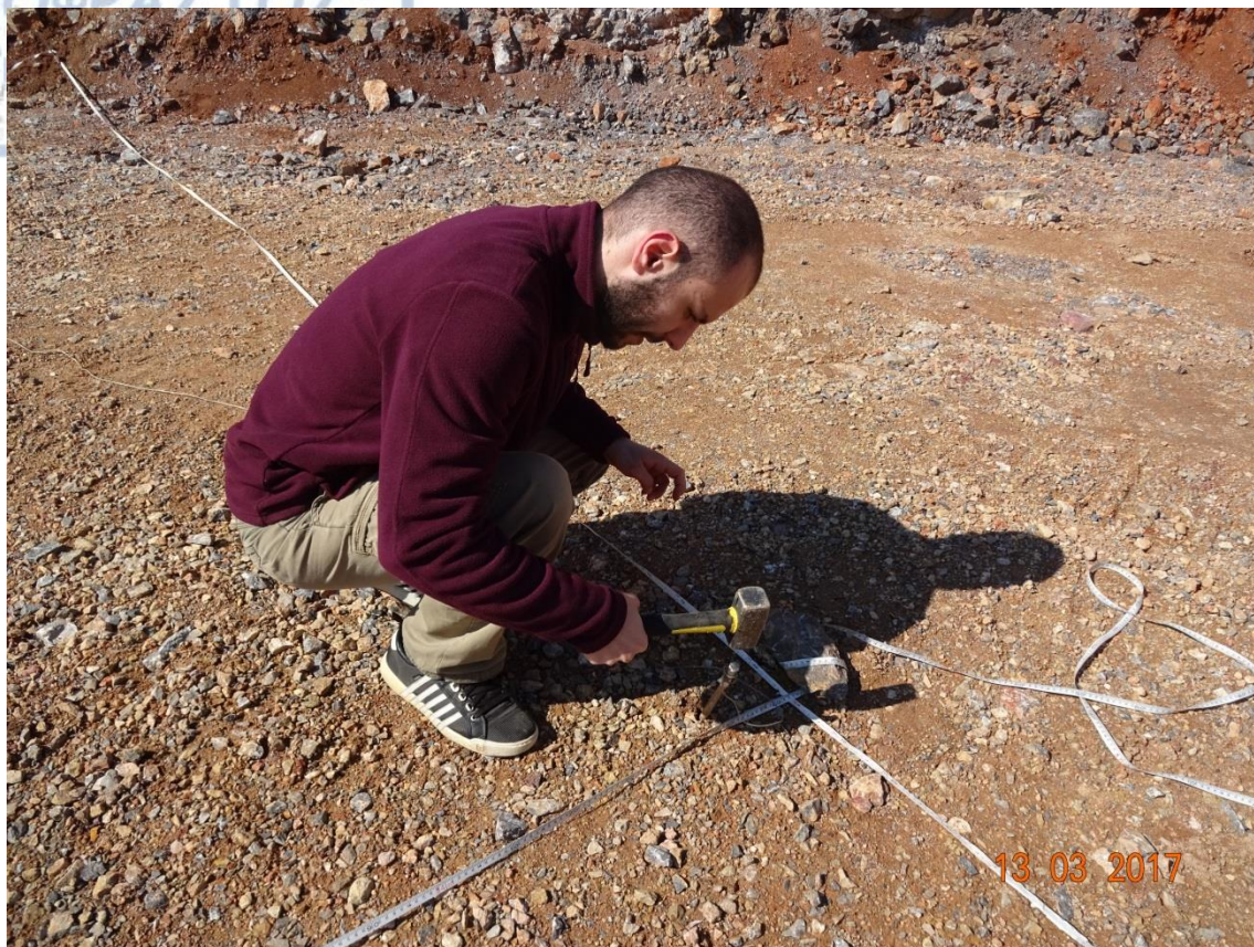
Εικόνα 19: Το κάρφωμα των ηλεκτροδίων στο έδαφος, διακρίνεται και πάλι η σταθερή κορδέλα καθώς και η κινητή που είναι κάθετη σε αυτήν.
