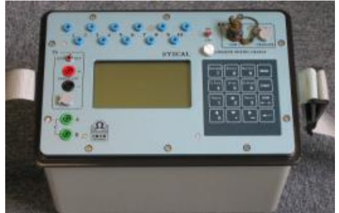
Εικόνα 13: Το γεωηλεκτρικό όργανο SYSCAL-Pro της εταιρείας IRIS INSTRUMENTS που χρησιμοποιήθηκε για τη λήψη των μετρήσεων
