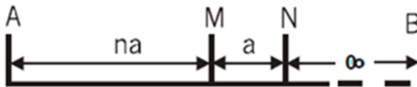
Εικόνα 9: Σχηματική απεικόνιση διάταξης πόλου- διπόλου.
