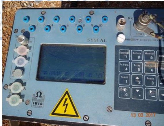
Εικόνα 13: Το γεωηλεκτρικό όργανο SYSCAL-Pro της εταιρείας IRIS INSTRUMENTS που χρησιμοποιήθηκε για τη λήψη των μετρήσεων
