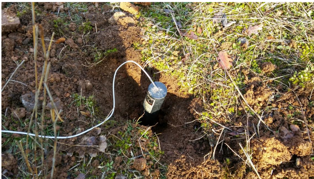
Σχήμα 23 Το κινούμενο ηλεκτρόδιο κατά την διάρκεια της μέτρησης.
