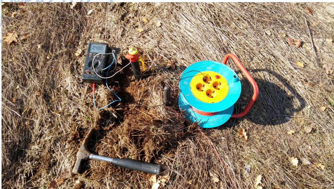
Σχήμα 22 Ο εξοπλισμός (βολτόμετρο, ηλεκτρόδια, καρούλι, καλώδιο, γεωλογικό σφυρί).
