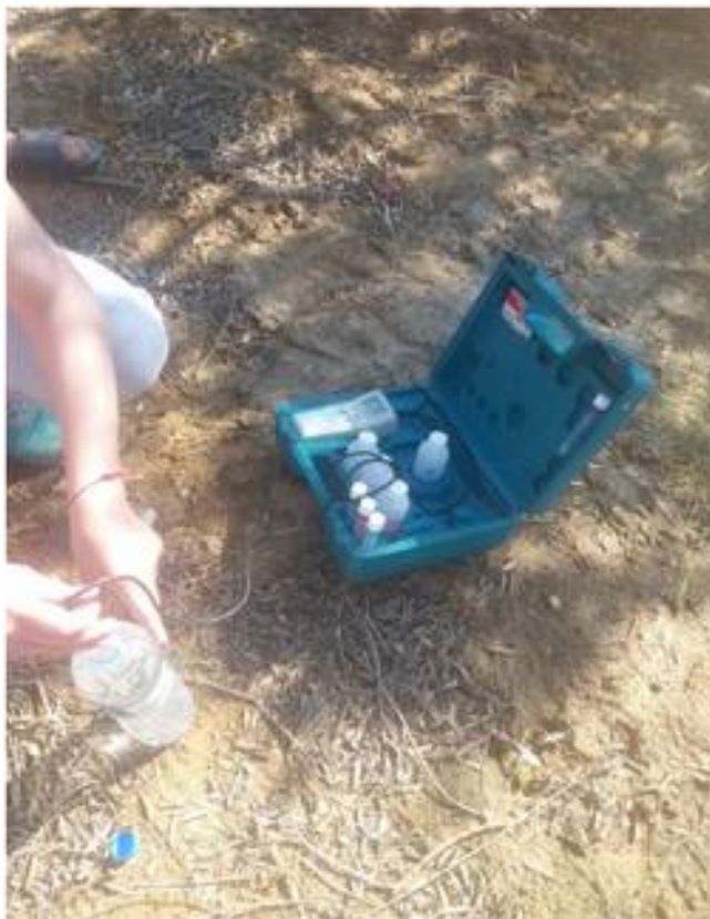
Σχήμα 18: Προσδιορισμός των φυσικοχημικών παραμέτρων νερού με αγωγιμόμετρο
