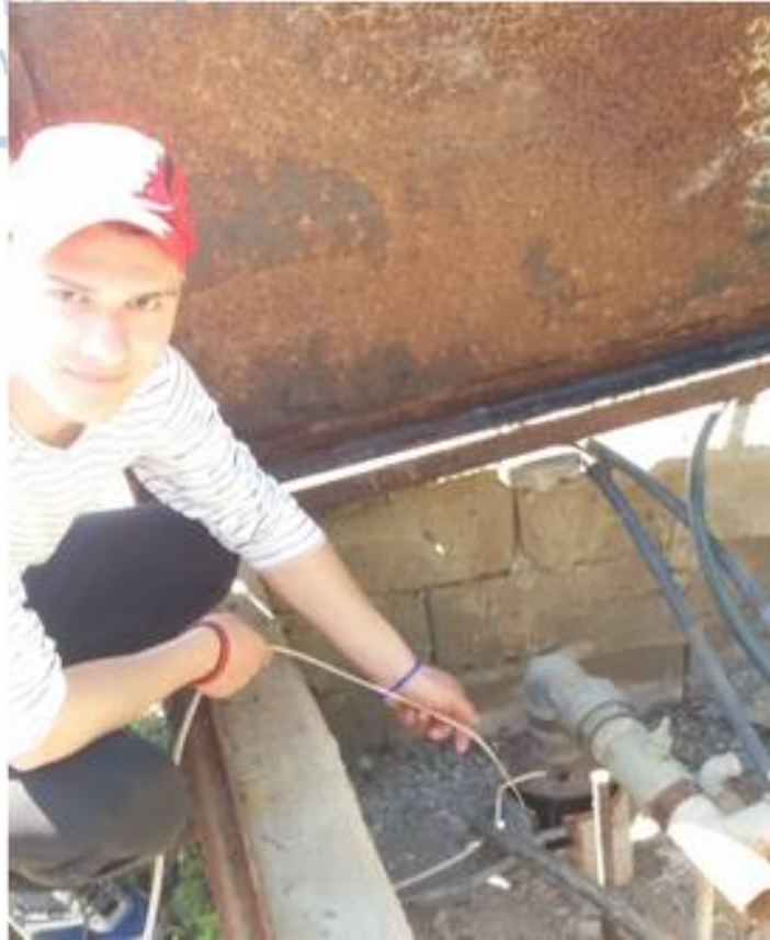
Σχήμα 14: Μέτρηση στάθμης υπόγειου νερού με τη χρήση σταθμήμετρου (Νησί-Βατοπέδι)
