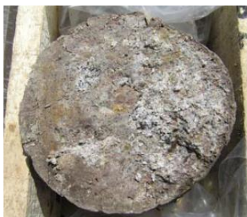
Σχήμα 2.3 Λεπτομέρεια στρώσεων της Ψαμμιτομαργαϊκής σειράς από πυρήνες γεωτρήσεων. Στρώση χαρακτηριστικής τεφροϊδούς ηφαιστειακής χονδρόκοκκης άμμου από γεωτρήσεις στην Άνω Περαία (Ζερμπούλου, 2010).
