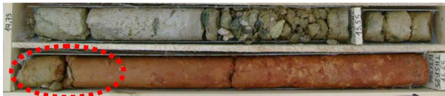
Σχήμα 2.4 Πυρήνες από γεώτρηση του Μετρό Θεσσαλονίκης στην περιοχή του Παπάφειου όπου φαίνεται η ομαλή μετάβαση από την σειρά των Ερυθρών Αργίλων στην Ψαμμιτομαργαϊκή σειρά (σύμφωνη στρωματογραφική επαφή)(Ζερβοπούλου, 2010).
