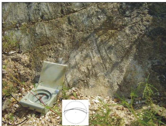
Σχήμα 8.4 Επιφάνεια του ρήγματος του Ανθεμούντα στην περιοχή του Γαλαρινού μέσα στους οφειόλιθους (Ζερβοπούλου, 2010). Διακρίνεται η γραμμωση ολίσθησης κατά μήκος της οποίας μετρήθηκε η γωνία pitch.
