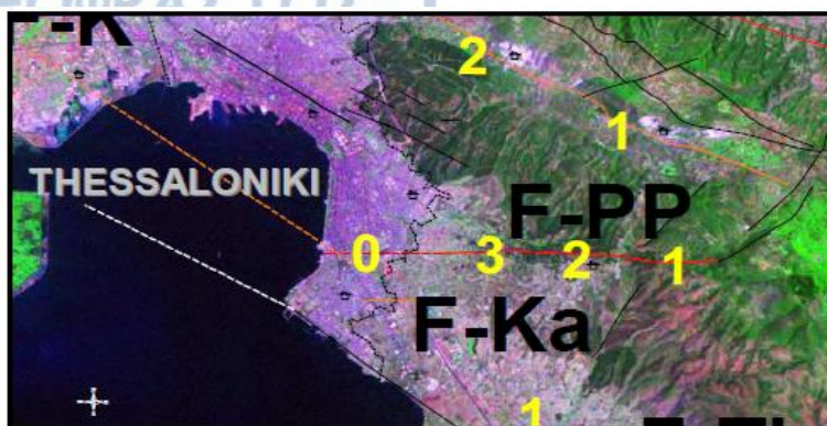
Σχήμα 8.20 Το ρήγμα Πυλαίας-Πανοράματος και τα διάφορα τμήματα (segments) στα οποία αυτό έχει χωριστεί (Ζερβοπούλου, 2010).
