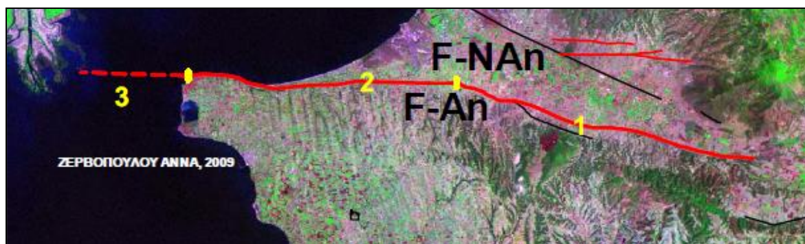
Σχήμα 8.7 Τμηματοποίηση του ρήγματος του Ανθεμούντα (Ζερβοπούλου, 2010).
