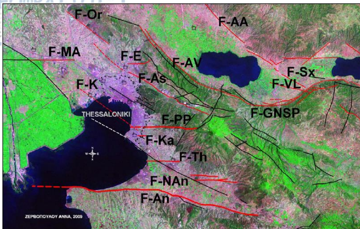
Σχήμα 8.1 Ρήγματα της περιοχής της Θεσσαλονίκης. ( Ενεργά Ρήγματα: F-An: Ανθεμούντα, F-GNSP: Γερακαρούς-Νικομηδινού-Στίβου-Περιστερώνα, F-PP: Πυλαίας-Πανοράματος, F-MA: Αγχιάλου-N. Μεσημβρίας, Πιθανά Ενεργά Ρήγματα: F-Th: Θέρμης-Αεροδρομίου, F-NAn: Βόρειου Ανθεμούντα, F-As: Ασβεστοχωρίου, F-E: Ευκαρπίας, F-K: Καλοχωρίου, Ρήγματα άγνωστης ενεργότητας πολεοδομικού συγκροτήματος: F-Ka: Καλαμαριάς) (Ζερβοπούλου, 2010).
