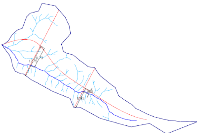
Σχήμα 7.19 Μετρήσεις για τον υπολογισμό του δείκτη εγκάρσιας τοπογραφικής συμμετρίας για την υπολεκάνη του Ξηροποτάμου (Ζερβοπούλου, 2010).
