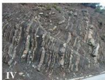
Τύπος IV. Μέτρια διαταραγμένη βραχώμαζα αποτελούμενη από εναλλαγές ψαμμίτη-ιλυολίθου σε ίσες αναλογίες
