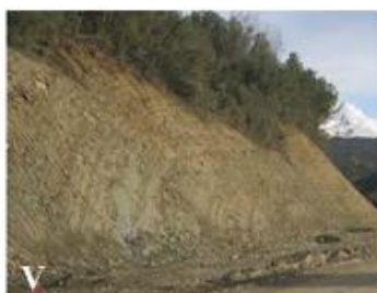
Τύπος V. Μέτρια διαταραγμένη βραχώμαζα αποτελούμενη από ιλυόλιθο με ενστρώσεις ψαμμίτη
