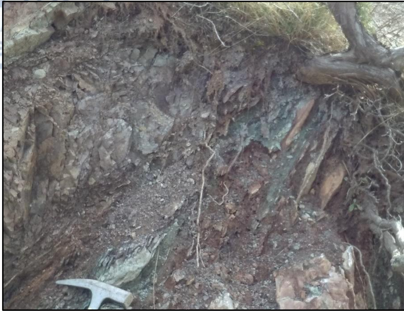
Εικόνα 5. 39 Εικόνα φλύσχη τύπου XI που συναντάται στην περιοχή (φωτογραφία από τον συγγραφέα).
