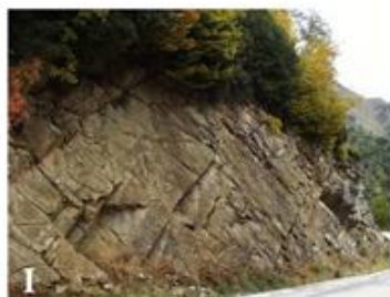
Τύπος I. Αδιατάρακτος μεσοστρωματώδης έως παχυστρωματώδης ψαμμίτης με σποραδικές λεπτές ενστρώσεις ιλυολίθου
