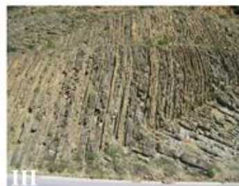
Τύπος III. Μέτρια διαταραγμένος ιλυόλιθος με ενστρώσεις ψαμμίτη
