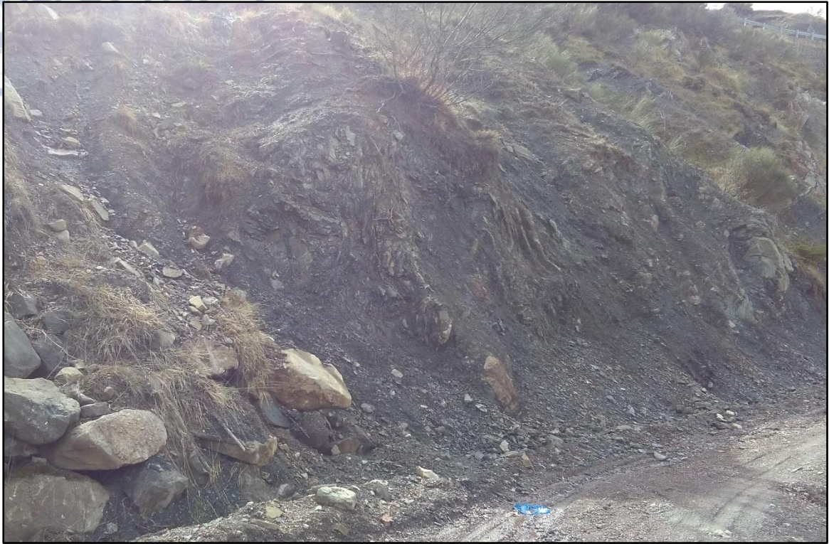
Εικόνα 5. 24 Εικόνα φλύσχη τύπου Χ που συναντάται στην περιοχή (φωτογραφία από τον συγγραφέα).
