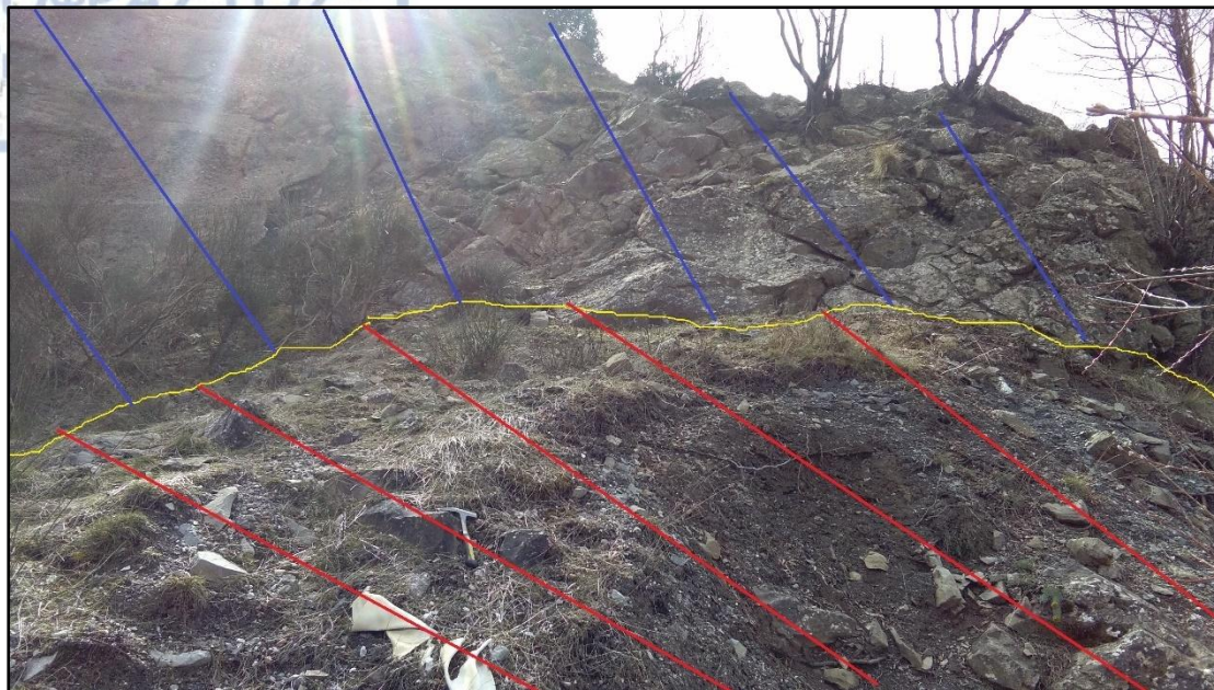
Εικόνα 5. 36 Δυτικό όριο κατολίσθησης, με κίτρινο η επαφή του φλύσχη τύπου X (κόκκινο) με παχυστρωματώδεις ψαμμίτες (μπλε) (φωτογραφία από τον συγγραφέα).
