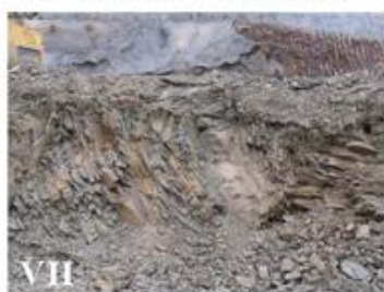
Τύπος VII. Έντονα διαταραγμένη – πτυχωμένη βραχώμαζα η οποία διατηρεί τη δομή της και αποτελείται από εναλλαγές ψαμμίτη – ιλυολίθου σε ίσες αναλογίες
