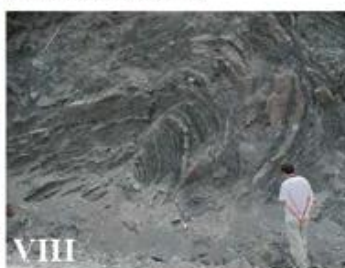
Τύπος VIII. Έντονα διαταραγμένη – πτυχωμένη βραχώμαζα η οποία διατηρεί τη δομή της και δεν έχει παραμορφωθεί – διατηρείται σε μεγάλο βαθμό και αποτελείται κυρίως από ιλυόλιθο με ενστρώσεις ψαμμίτη
