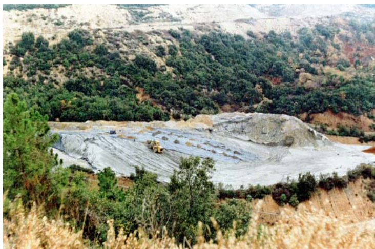
Σωροί σιδηροπυρίτη στο μεταλλείο Μαντέμ Λάκκου σκεπασμένοι με πλαστικό για την παρεμπόδιση εισόδου νερών της βροχής.
