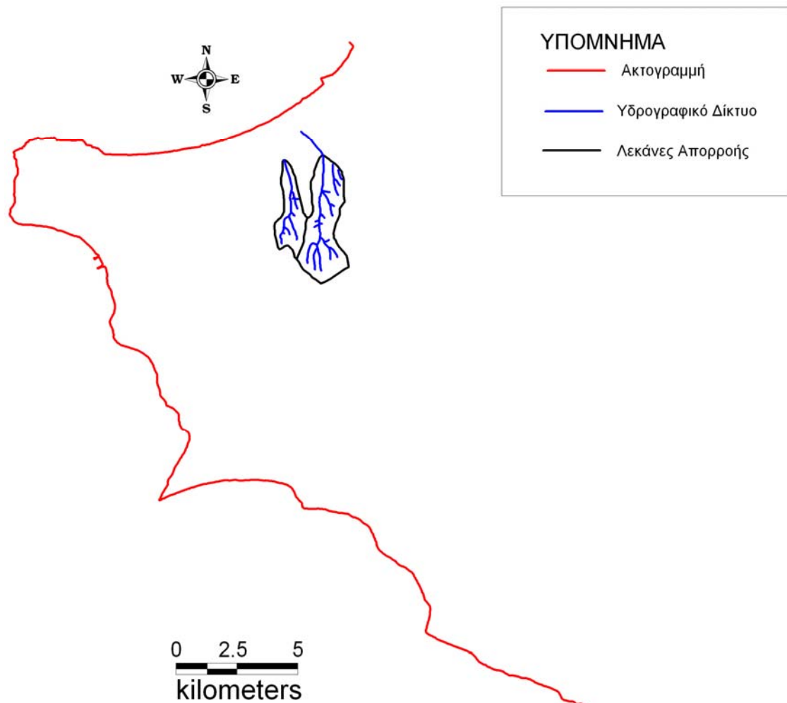
Σχήμα 10. Χάρτης υδρογραφικού δικτύου και λεκανών που παρουσιάζουν ασύμμετρη ανάπτυξη.
