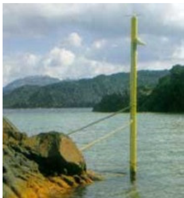
Φωτογραφία 5.1 Παλιρροιογράφος υπερήχων του πilotικού συστήματος στην Παλαιά Καμμένη.
