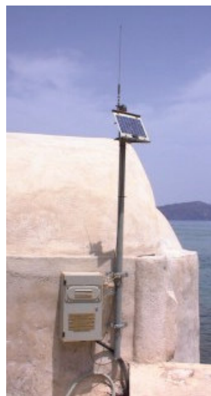
Φωτογραφία 5.3 α) Παλιρροιογράφος μετατροπής της πίεσης του νερού στο σταθμό «Ερινιά» στην Ν. Καμμένη, β) άποψη του σταθμού «Άγιος Νικόλαος» στην Π. Καμμένη.
