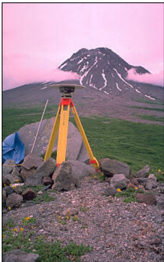
Σχήμα 3.6 Δέκτης GPS στο ηφαίστειο Augustine, Αλάσκα, 1995 (από USGS).
