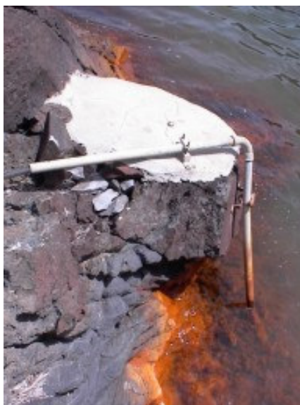
Φωτογραφία 5.3 α) Παλιρροιογράφος μετατροπής της πίεσης του νερού στο σταθμό «Ερινιά» στην Ν. Καμμένη, β) άποψη του σταθμού «Άγιος Νικόλαος» στην Π. Καμμένη.
