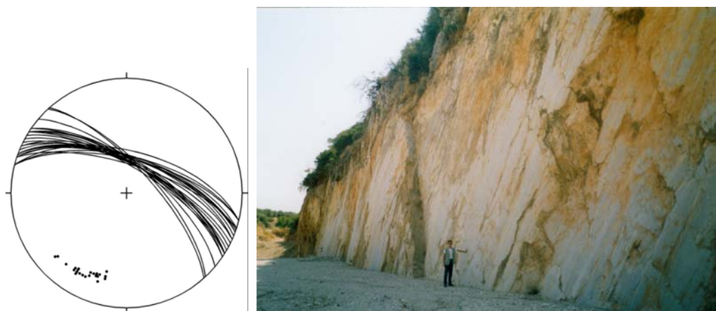
Σχήμα 2.4. Αριστερά: Μετρήσεις ρηξιγενών επιφανειών κατά μήκος του ρήγματος της Αταλάντης. Δεξιά: Κατοπτρική επιφάνεια του ρήγματος του Ασπρορέματος. (Παυλίδης 2004)
