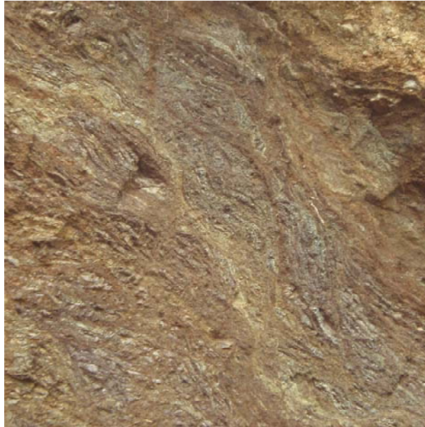
Figure 34 Κανονικές ρηξιγενείς επιφάνειες, μεγάλης γωνίας κλίσης όμως, με ανάλογη παραμόρφωση των στρωμάτων των ραδιολαριτών-πηλιτών, στην περιοχή της Κορομηλιάς.
