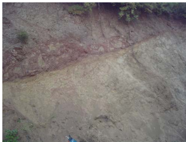
Figure 32 Τεκτονική επαφή οφειολίθων-πηλιτών μικρής γωνίας κλίσης και με στοιχεία 192/32. Σχηματισμός πιθανού τεκτονικού λατυποπαγούς.
