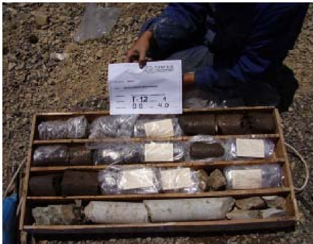
Ερευνητική Γεώτρηση Γ12. Βάθος : 0.00 – 4.00 m.
