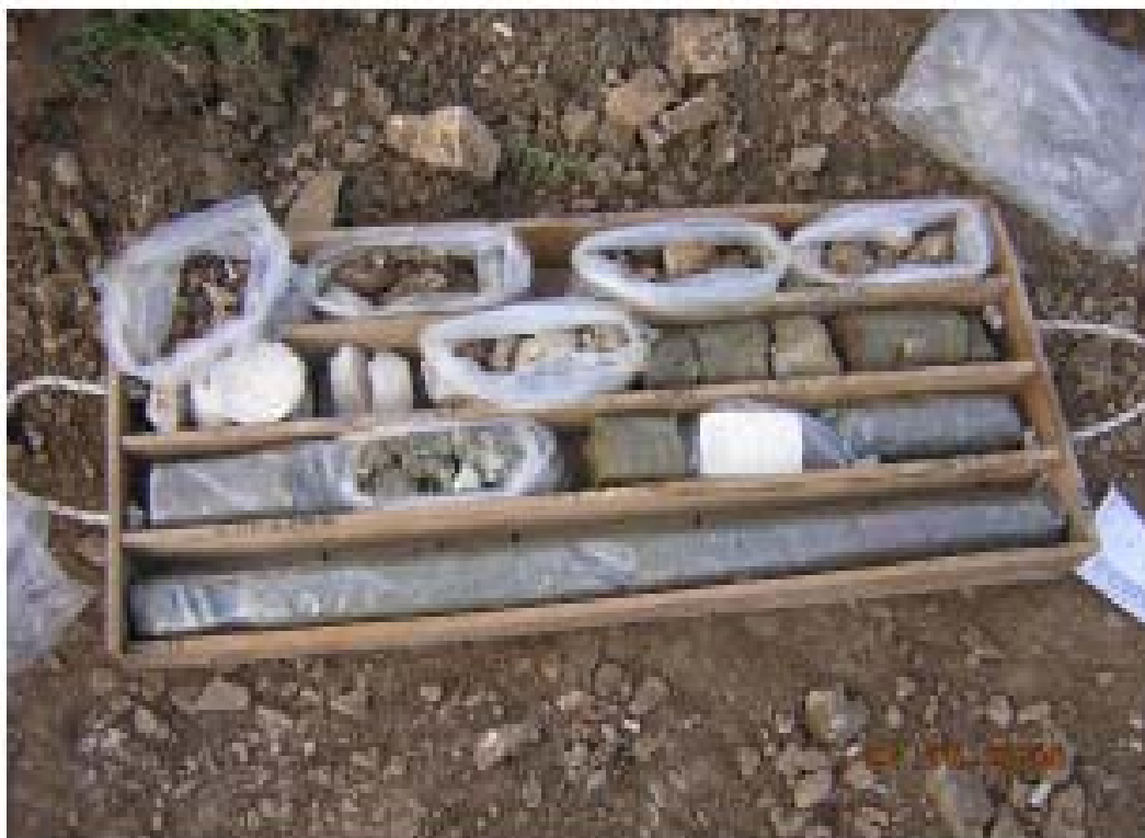
Ερευνητική Γεώτρηση Γ9. Βάθος : 0.00 – 4.10 m.
