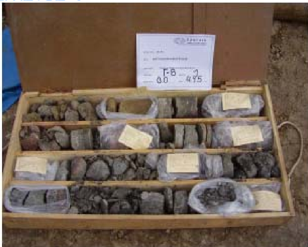
Ερευνητική Γεώτρηση Γ8. Βάθος : 0.00 – 4.95 m.
