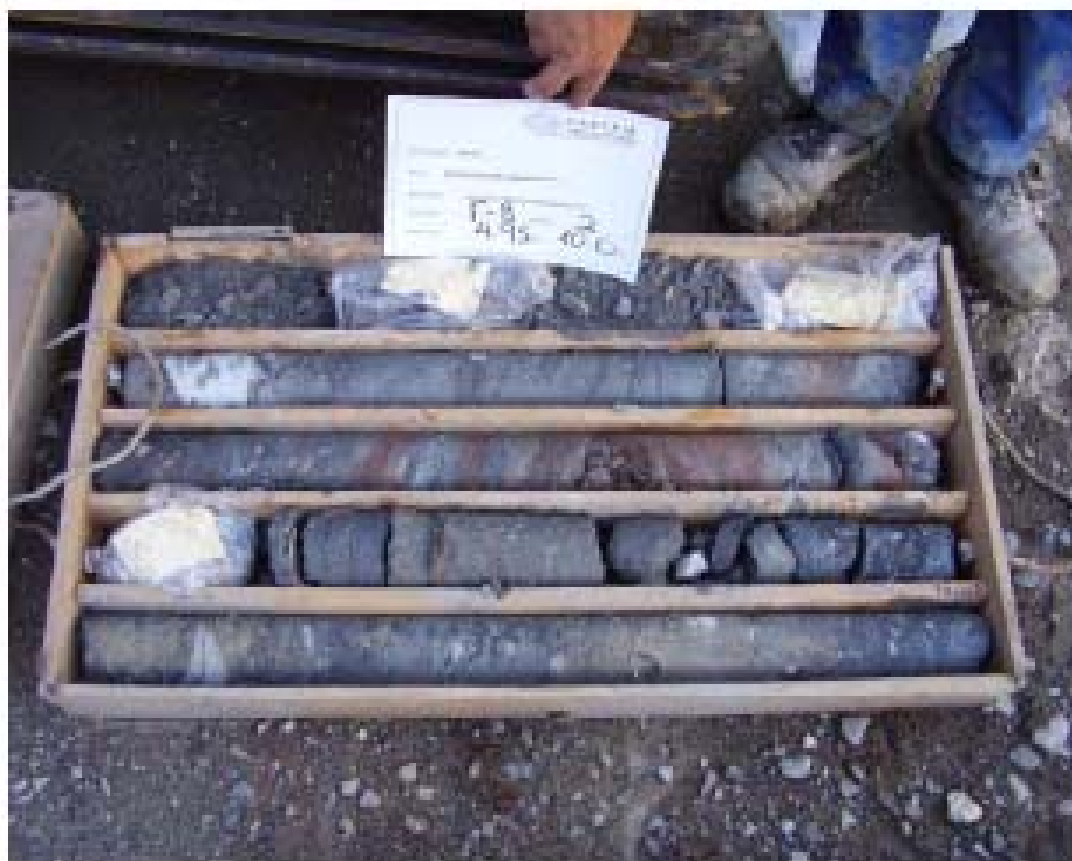
Ερευνητική Γεώτρηση Γ8. Βάθος : 4.95 – 10.00 m.
