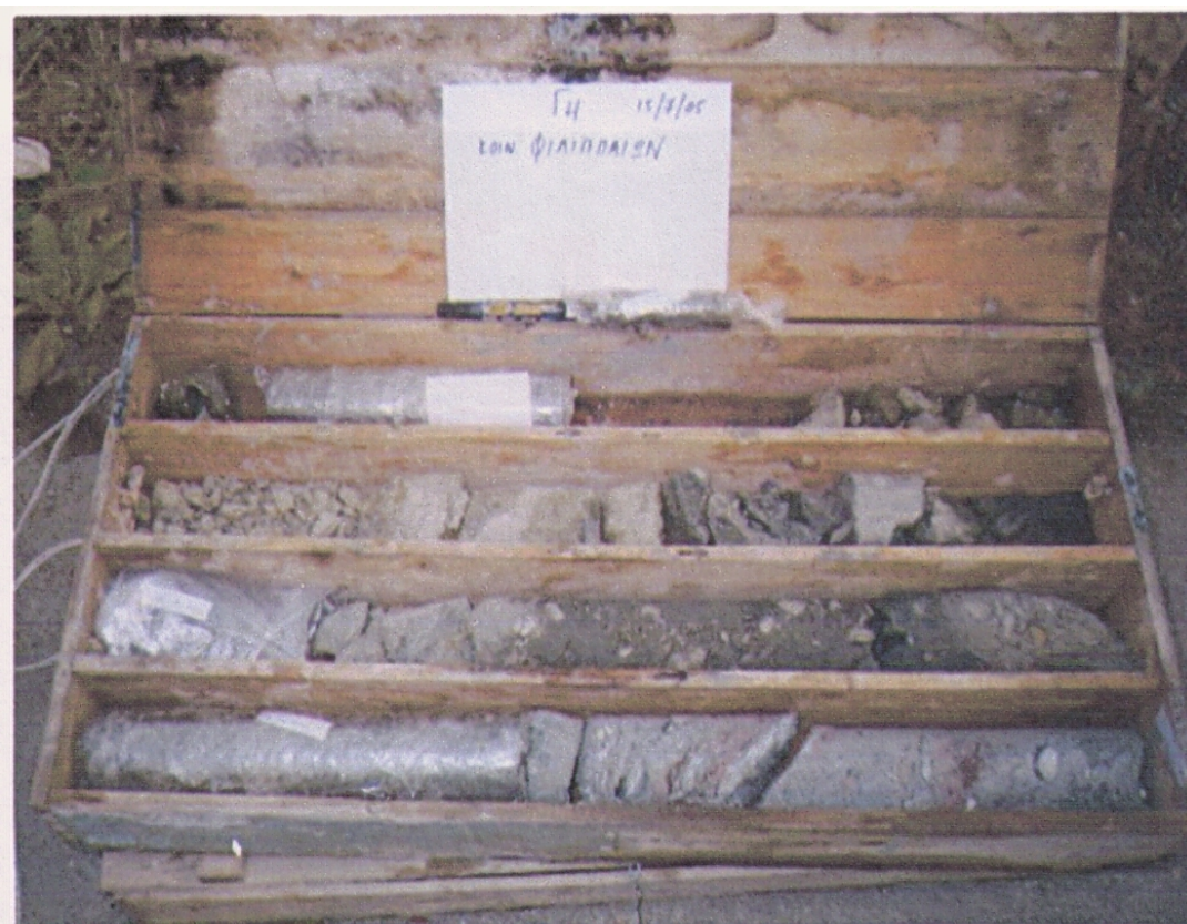
Ερευνητική Γεώτρηση Σ4. Βάθος : 5.00 – 10.50 m.
