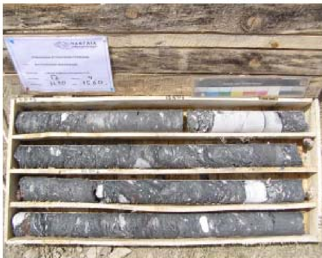
Ερευνητική Γεώτρηση Γ6. Βάθος : 11.90 – 15.60 m.
