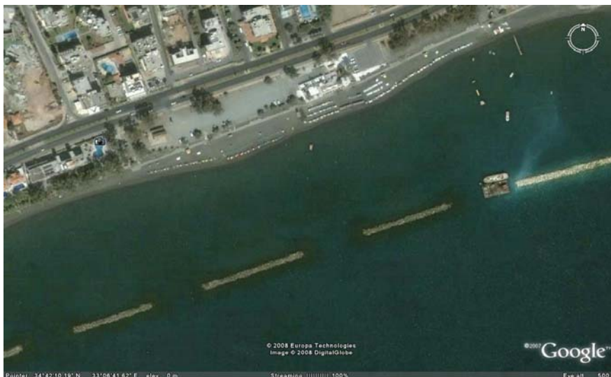
(Παρ/λοι κυματοθραύστες στο παραλιακό μέτωπο της παραλίας Λεμεσού) – Πηγή:Google Earth
