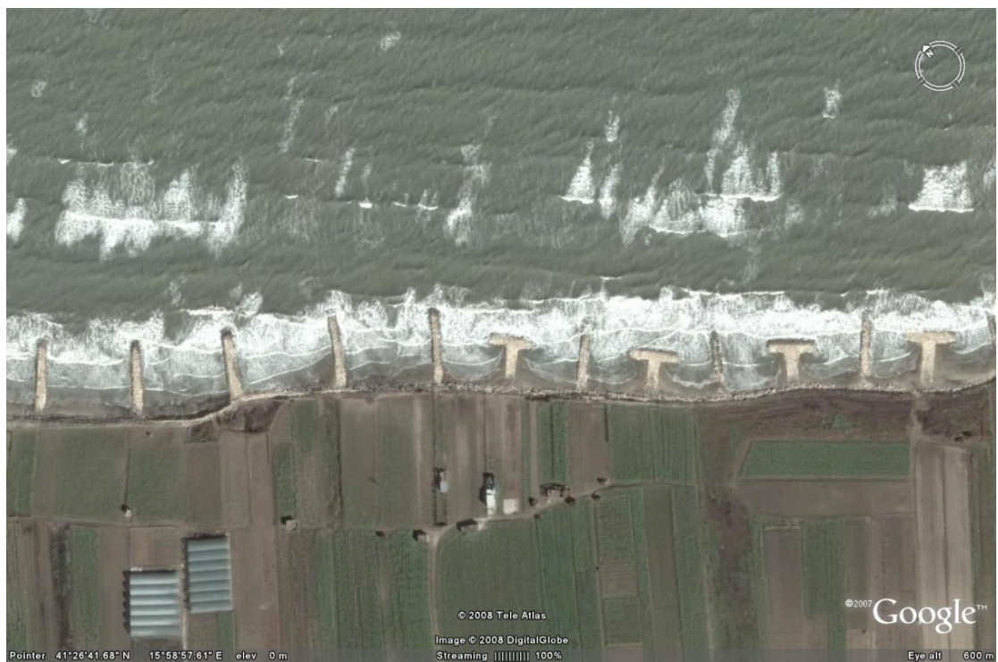
(Κάθετοι κυματοθραύστες όπου φαίνεται η δράση των κυμάτων-Ιταλία) - Πηγή:Google Earth
