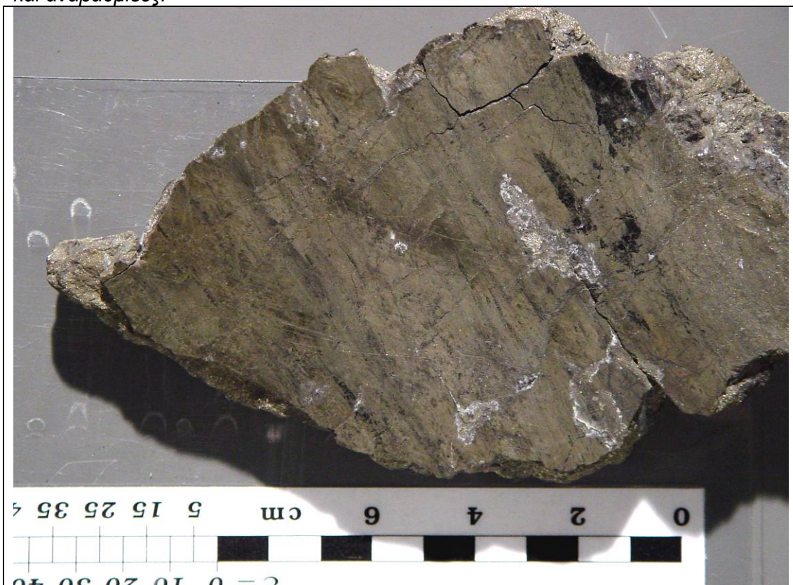
Σχήμα 39. Δείγμα 1 (Δ1) κατοπτρική ρηξιγενή επιφάνεια με γραμμώσεις ολίσθησης και αναβαθμίδες.
