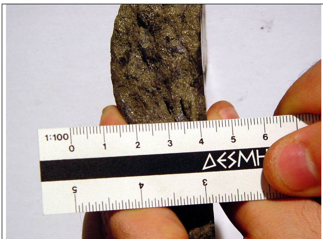
Σχήμα 41. Δείγμα 1 (Δ1) κατοπτρική ρηξιγενή επιφάνεια με γραμμώσεις ολίσθησης και αναβαθμίδες.
