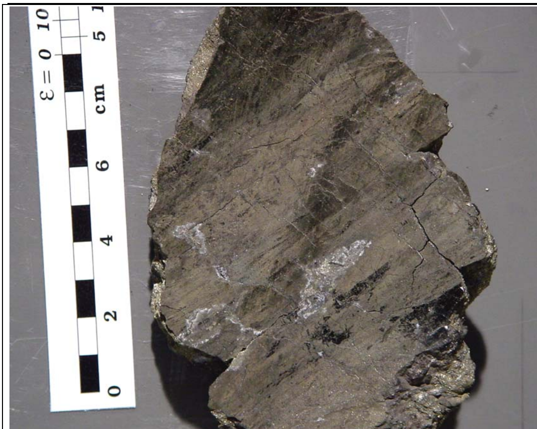
Σχήμα 38. Δείγμα 1 (Δ1) κατοπτρική ρηξιγενή επιφάνεια με γραμμώσεις ολίσθησης και αναβαθμίδες.
