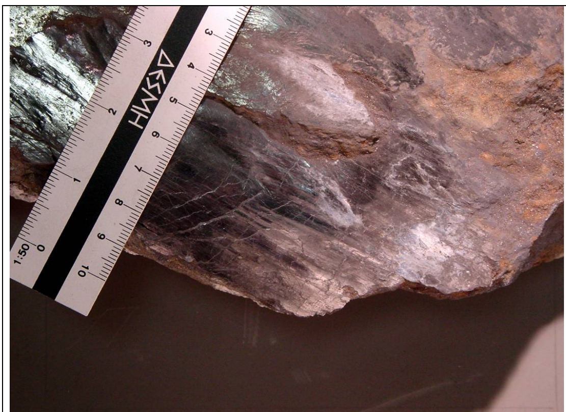
Σχήμα 45. Δείγμα 2 (Δ2) κατοπτρική ρηξιγενή επιφάνεια με γραμμώσεις ολίσθησης και αναβαθμίδες.
