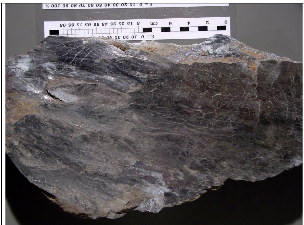
Σχήμα 43. Δείγμα 2 (Δ2) κατοπτρική ρηξιγενή επιφάνεια με γραμμώσεις ολίσθησης και αναβαθμίδες.
