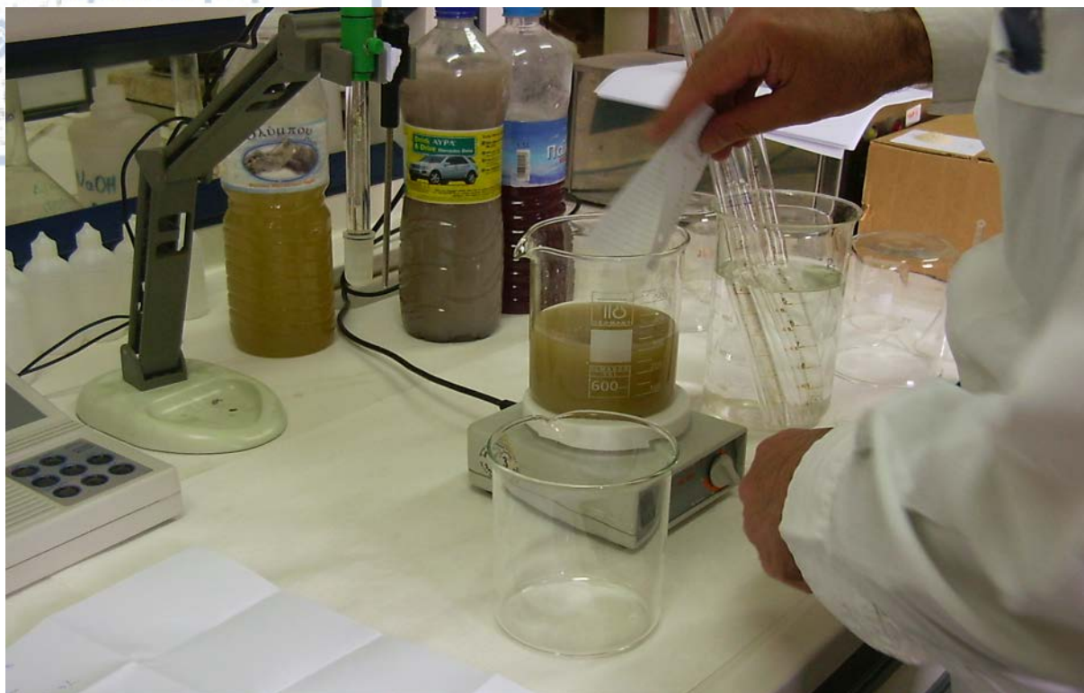
Εικόνα 1. Προσθήκη του Ζεολιθικού Τόφφου Πολύ Υψηλής Ποιότητας (ΖΤΠΥΠ) στο αστικό υγρό απόβλητο.
