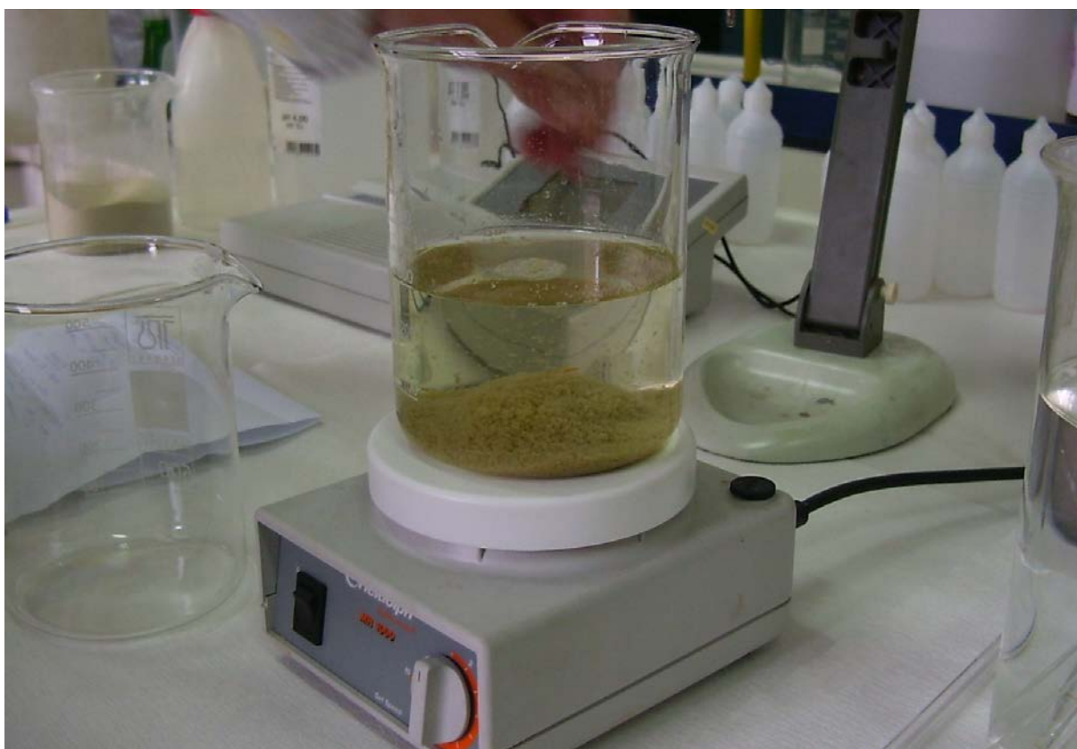
Εικόνα 4. Διαυγές νερό μετά την κατεργασία του αστικού υγρού απόβλητου με κροκιδωτικά και Ζεολιθικού Τόφφου Πολύ Υψηλής Ποιότητας (ΖΤΠΥΠ). (Πυθμένας) Άοσμη και συνεκτική ζεο-λυματολάσπη.
