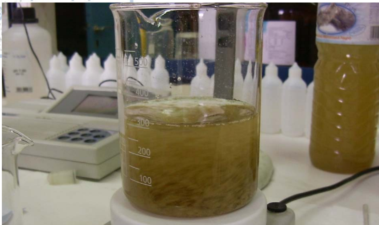
Εικόνα 3. Κλείσιμο του διακόπτη του μαγνητικού αναδευτήρα με αποτέλεσμα την εμφάνιση της κροκίδωσης-συσσωμάτωσης.
