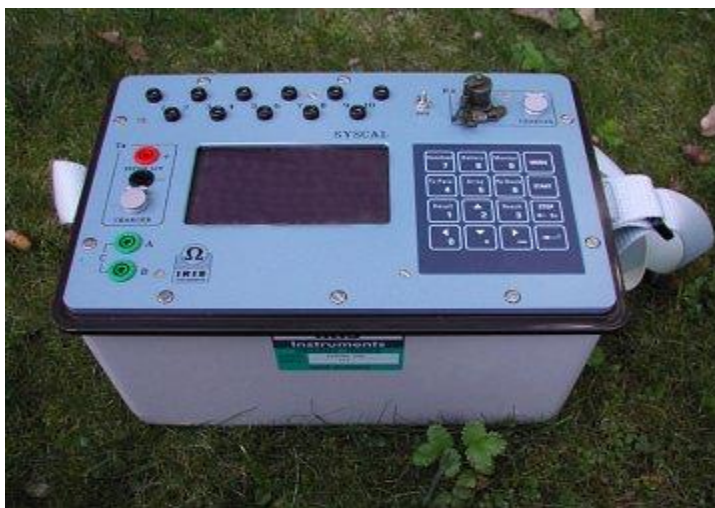
Φωτ. 2: Το γεωηλεκτρικό όργανο SYSCAL-Pro που χρησιμοποιήθηκε για τη λήψη των μετρήσεων
