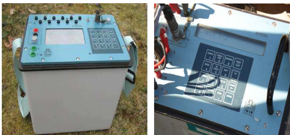
Σχήμα 3.2.1. SYSCAL , όργανο μέτρησης ειδικής ηλεκτρικής αντίστασης.
