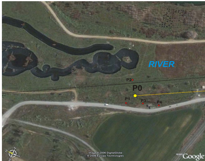
Σχήμα 2.3.1 Γεώτρηση εισπίεσης (P0) και γεωτρήσεις ελέγχου (P1, P2, P3, P4 )
