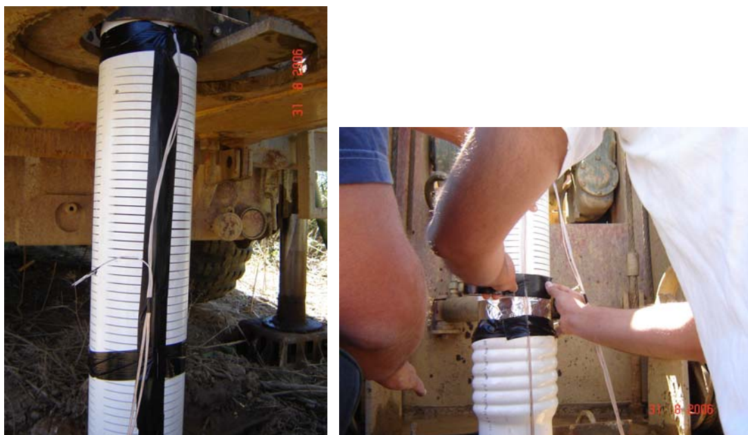
Σχήμα 3.1.1 Εγκατάσταση καλωδίων ERT
