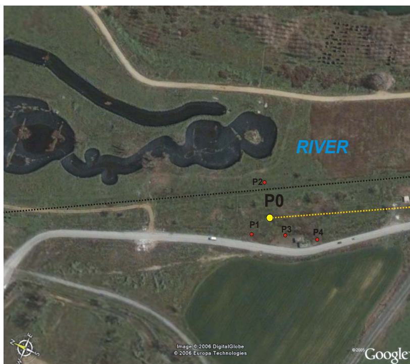
Σχήμα 2.3.1 Γεώτρηση εισπίεσης (P0) και γεωτρήσεις ελέγχου (P1, P2, P2, P4 )
