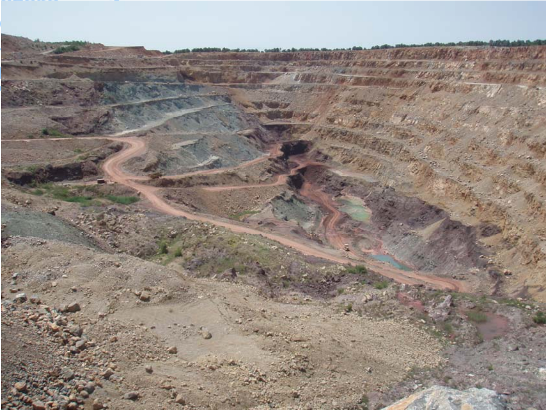
Εικόνα 6. Μεταλλείο Ίσωμα , εμφανώς διακρίνονται δεξιά οι Ανωκρητιδικοί ασβεστόλιθοι, το μετάλλευμα στο κέντρο και οι οφιόλιθοι αριστερά.
