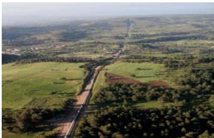
Εικόνα 9. Ταινία μεταφοράς μεταλλεύματος (Αποστολίκας 2007)
