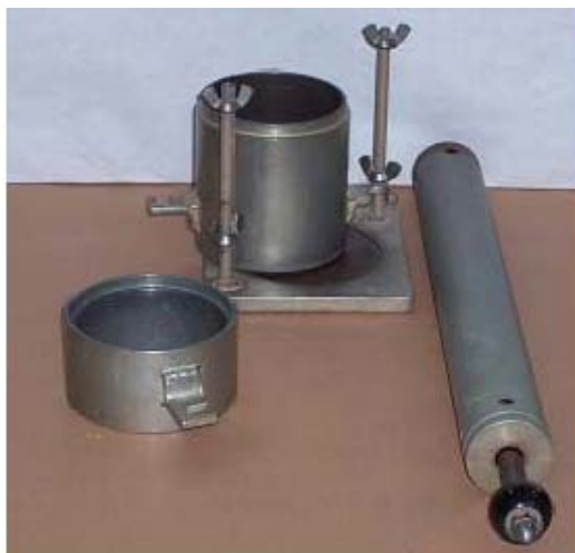
Εικόνες 7,8. Μήτρα, κόπανος και δακτύλιος για την δοκιμή συμπίκνωσης εδαφών.
