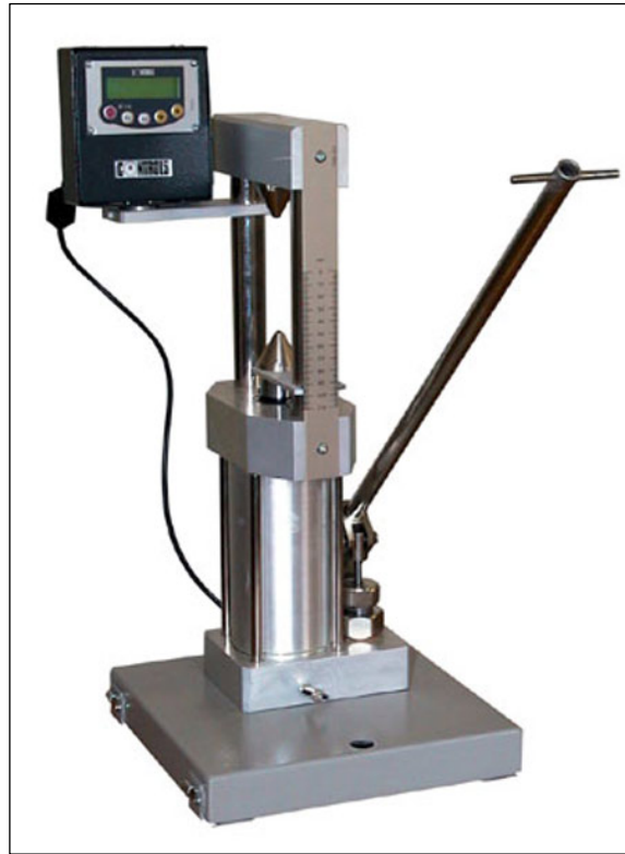
Εικόνα 14. Συσκευή σημειακής φόρτισης ( Point load ).
