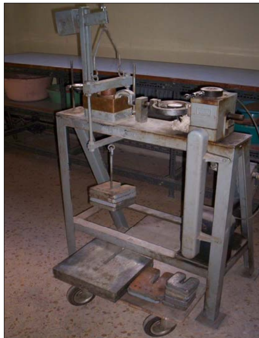
Εικόνες 9,10,11,12. Το κιβώτιο διάτμησης και η συσκευή άμεσης διάτμησης.
