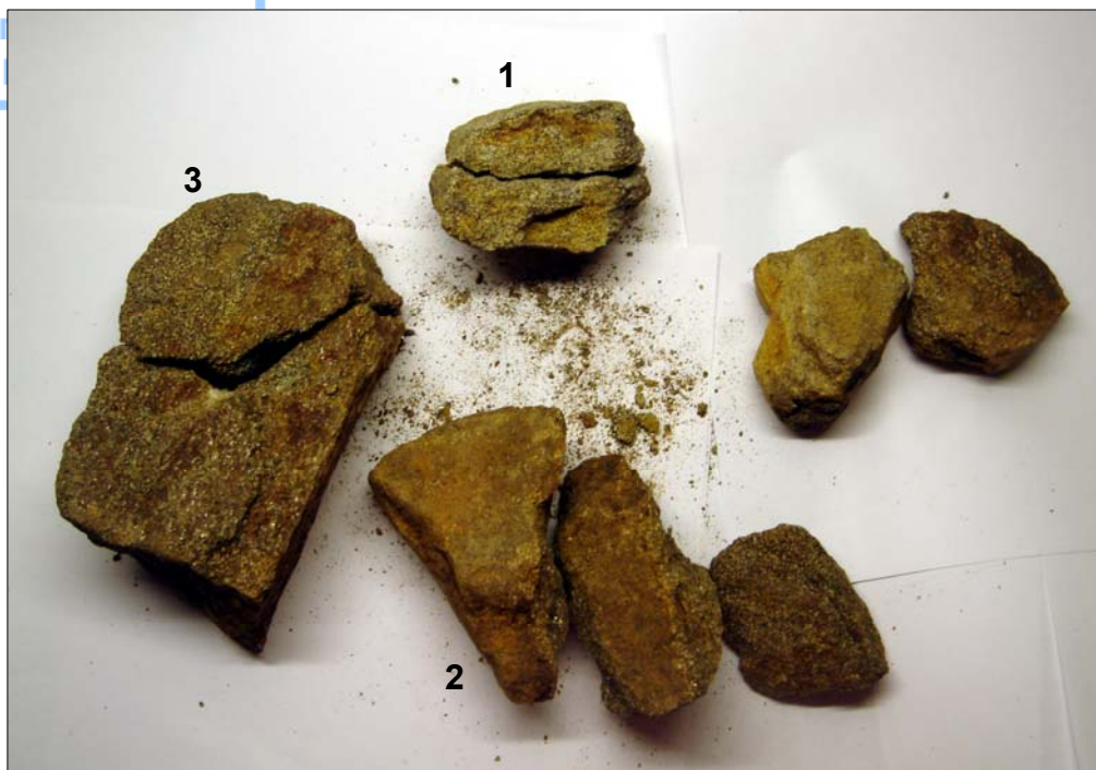
Εικόνα 24. Τα δείγματα στα οποία πραγματοποιήθηκαν δοκιμές Point load.
