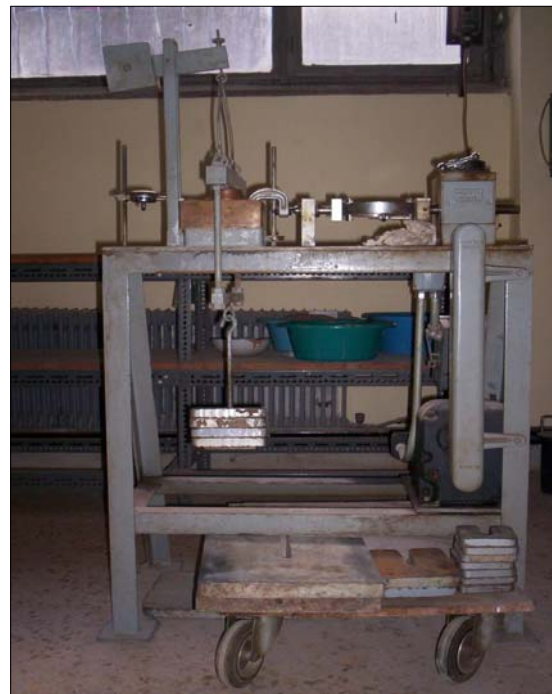
Εικόνες 9,10,11,12. Το κιβώτιο διάτμησης και η συσκευή άμεσης διάτμησης.
