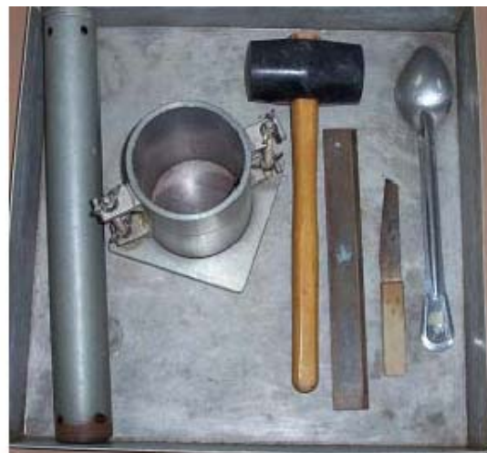
Εικόνες 7,8. Μήτρα, κόπανος και δακτύλιος για την δοκιμή συμπίκνωσης εδαφών.
