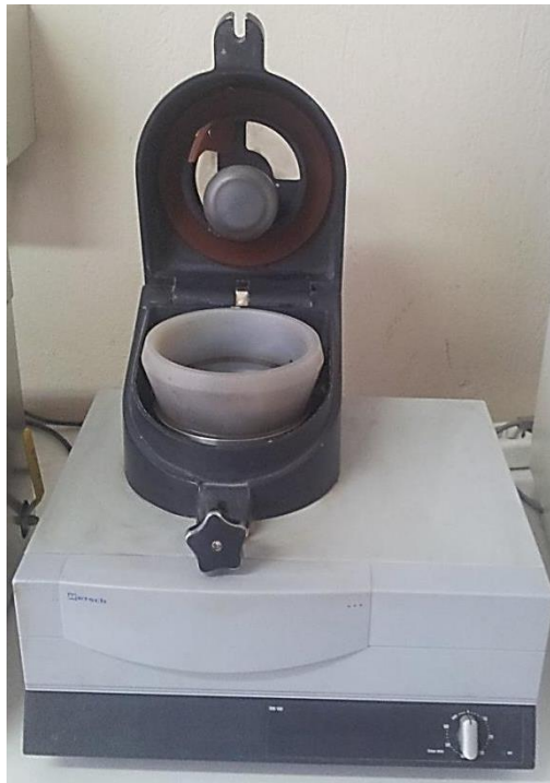
Εικόνα 23 Μηχανικό γουδί με εξοπλισμό αχάτη της εταιρίας Retsch που διαθέτει ο Τομέας Ορυκτολογίας-Πετρολογίας-Κοιτασματολογίας.
