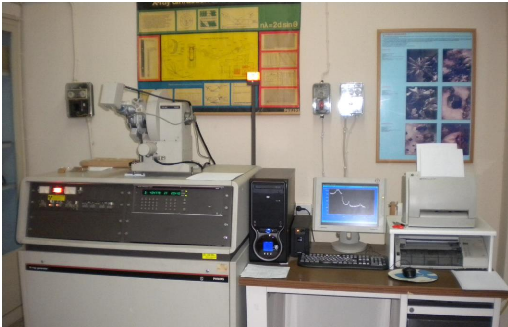
Εικόνα 20. Περιθλασίμετρο τύπου PHILIPS PW1710 του Τομέα Ορυκτολογίας-Πετρολογίας-Κοιτασματολογίας.
