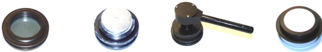
Εικόνα 24. Διαδικασία παρασκευής δοκιμίων για τη μέτρηση των χρωματικών παραμέτρων.
