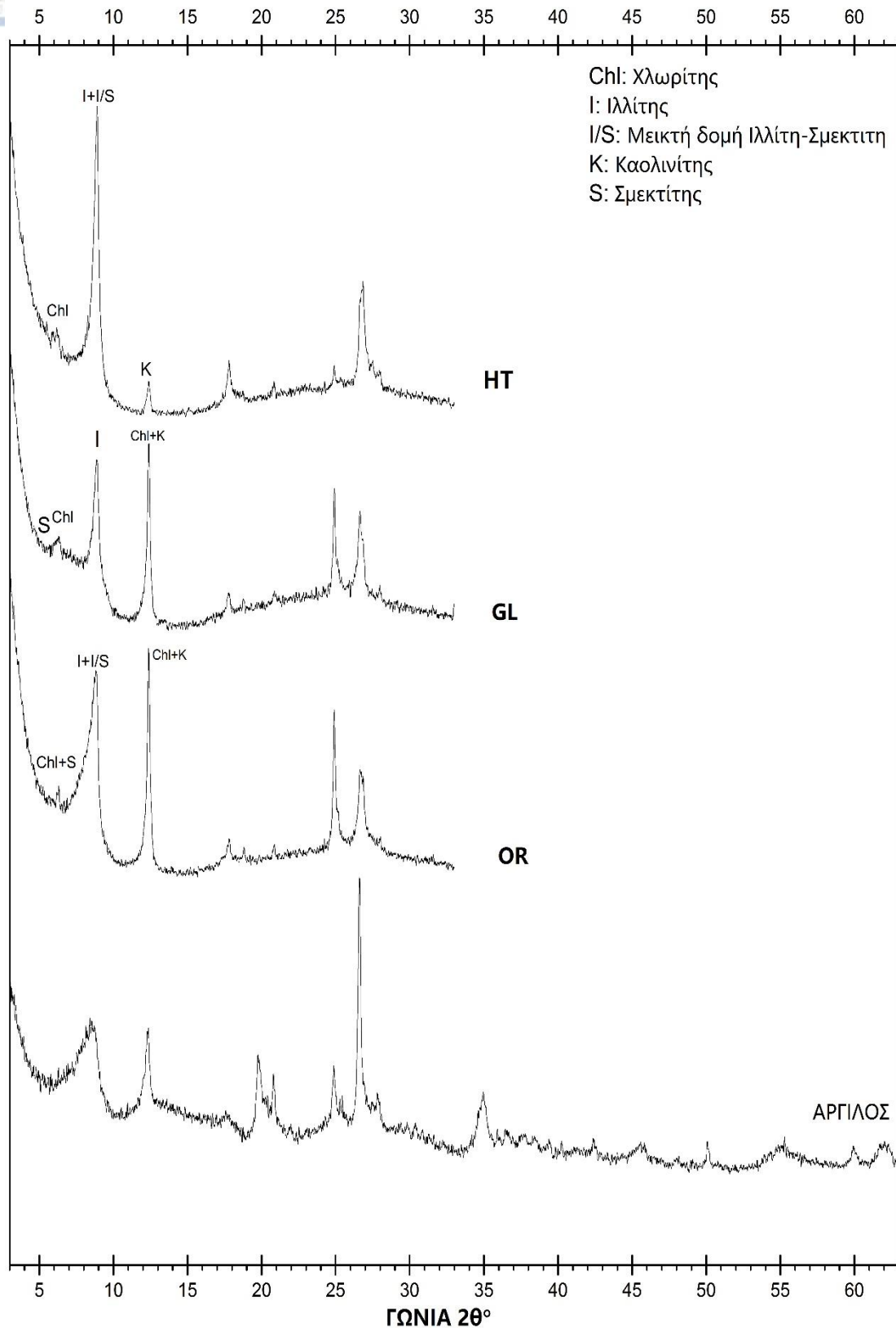
Περιθλασιόγραμμα αργιλικού κλάσματος δείγματος S5 (Πηλόλιθος).
