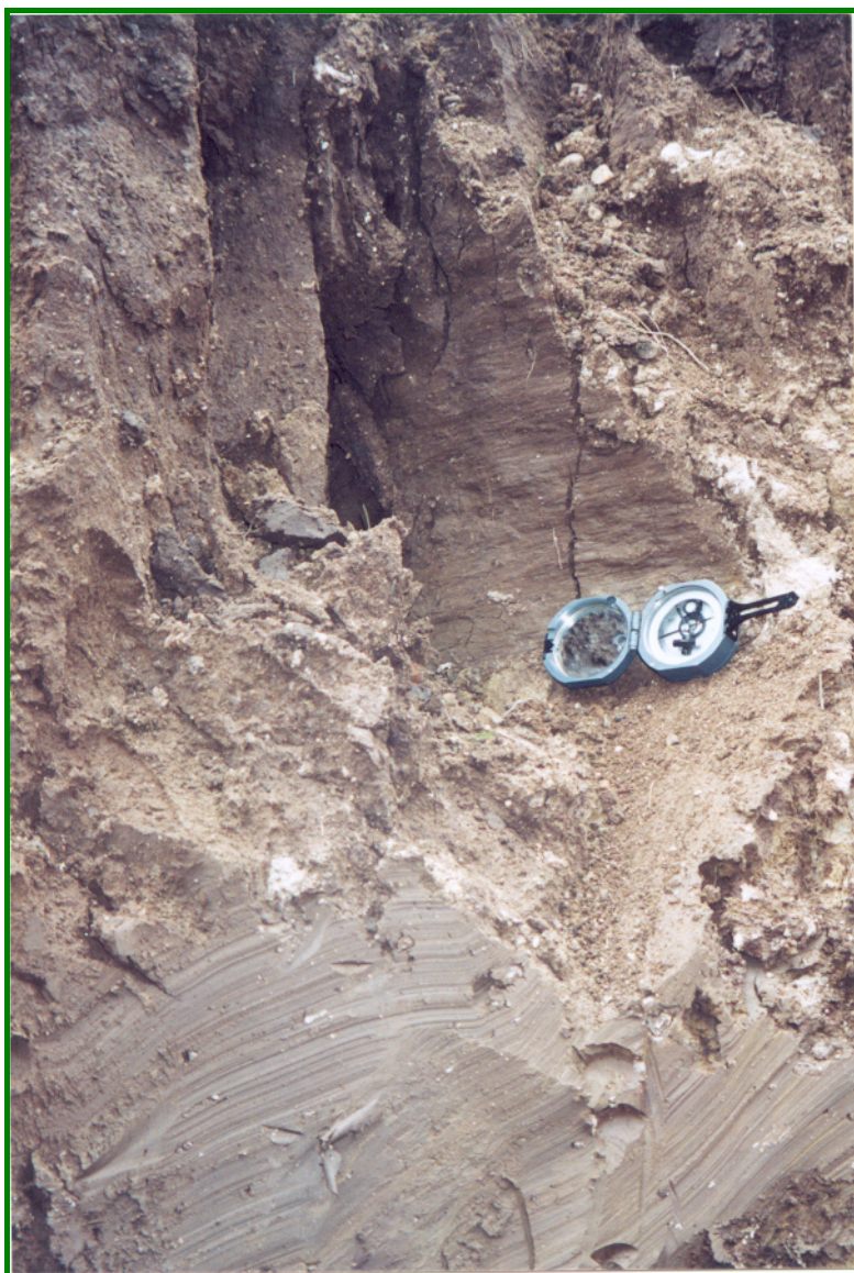
Εικόνα 4.5.3.6. Λεπτομέρεια της νότιας ρηξιγενούς ζώνης. Διακρίνονται οι γραμμώσεις ολί- σθησης, οι οποίες δείχνουν σχεδόν καθαρή οριζόντια δεξιόστροφη μετατόπιση.
