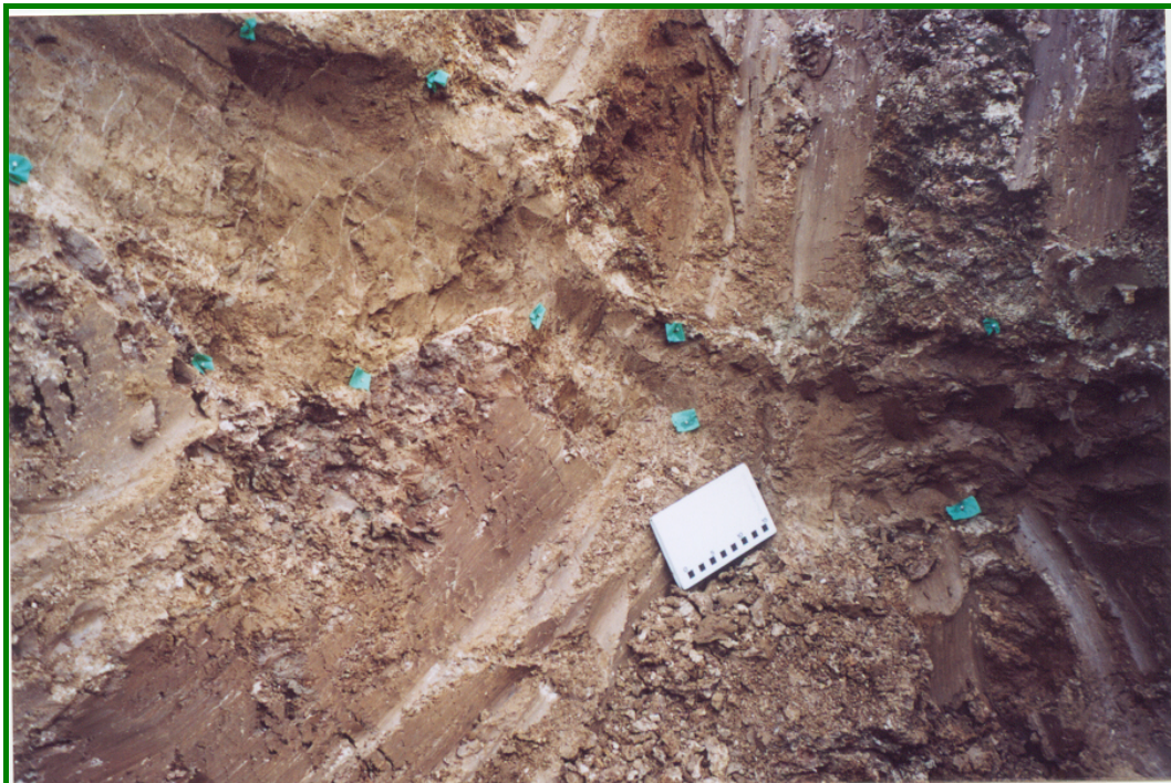
Εικόνα 4.5.3.4. Λεπτομέρεια της βόρειας ρηξιγενούς ζώνης στην τομή KY-1, όπου διακρίνεται πιθανή ρευστοποίηση στο άνω αριστερό μέρος της φωτογραφίας.
