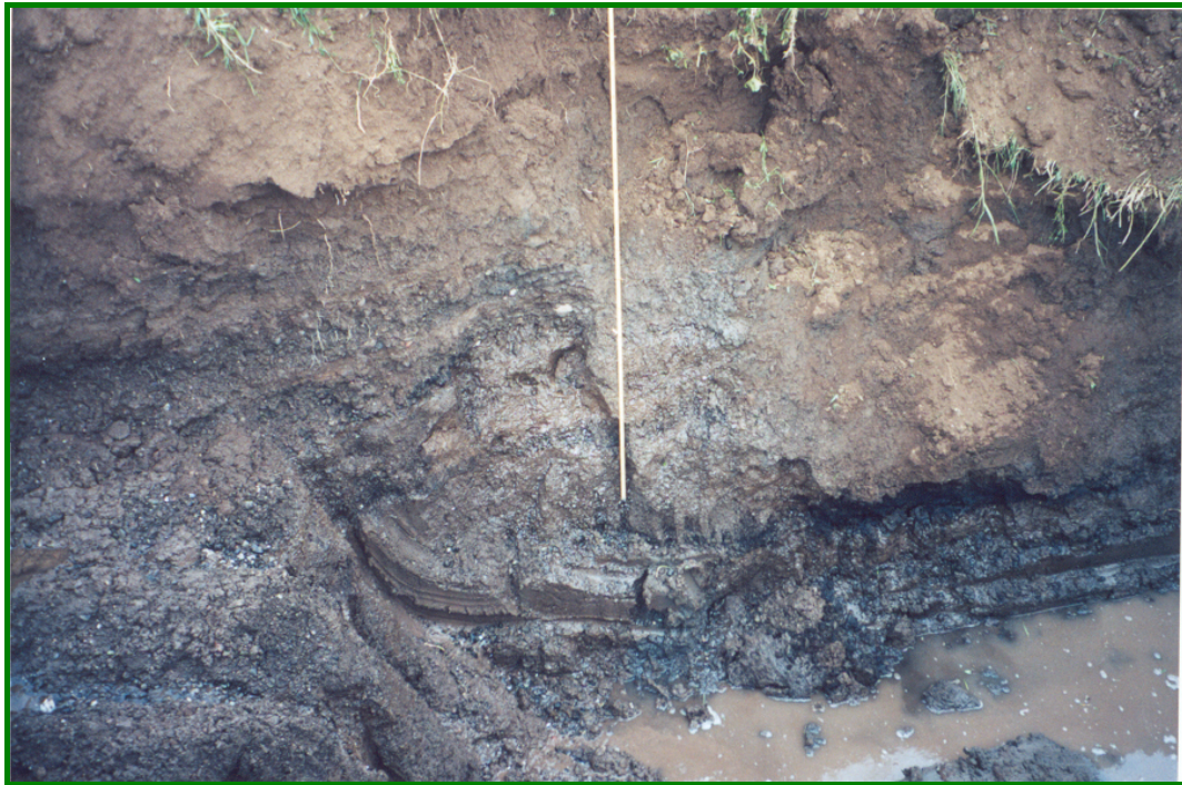
Εικόνα 4.5.2.7. Λεπτομέρεια του ανατολικού τοιχώματος της τομής ΑΥ-2, όπου διακρίνεται η μετατόπιση του οργανικού ιλυώδους ορίζοντα κατά περίπου 1 m προς Ν.
