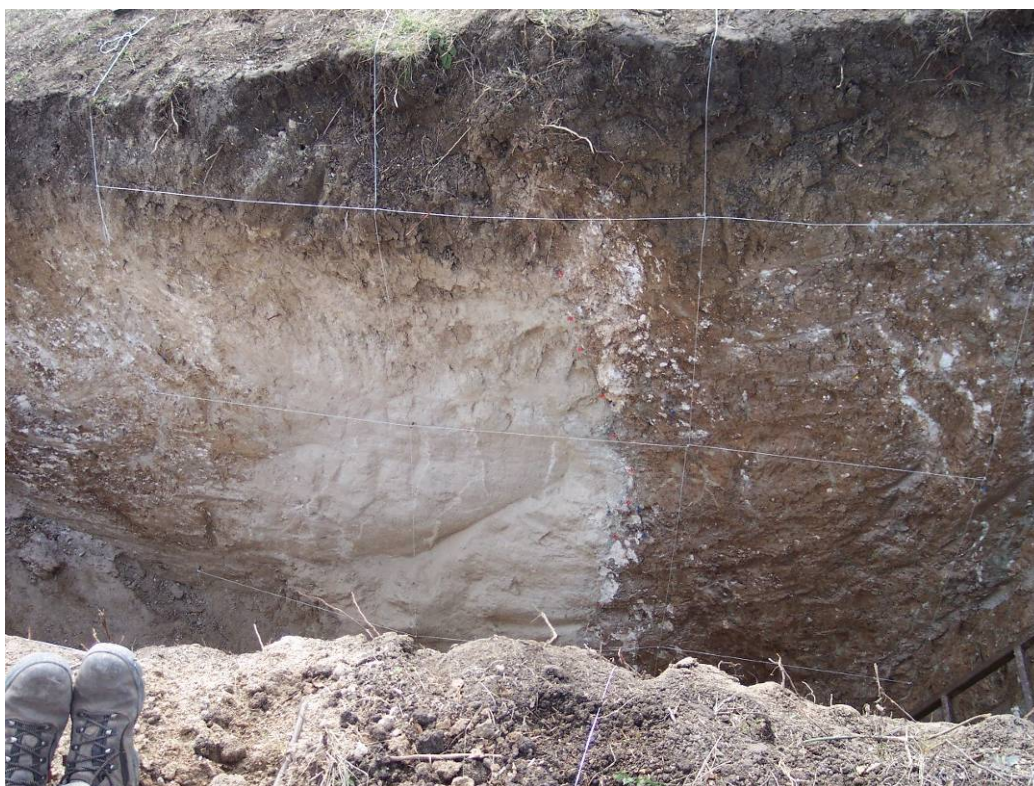
Εικόνα 4.6.1.13. Λεπτομέρεια της ρηξιγενούς ζώνης. Όριο μεταξύ μαζώδους αργιλλοαμμώδους υλικού και άμμου προερχόμενη από ρευστοποίηση. Χαρακτηριστική είναι η αύξηση των κροκαλών στο όριο. (Το σημείο βρίσκεται στο δυτικό τοίχωμα της τομής).
