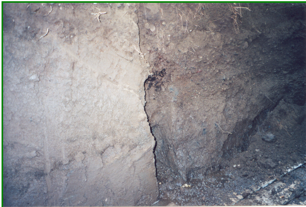
Εικόνα 4.5.2.2. Λεπτομέρεια της σεισμικής ρηξιγενούς ζώνης, όπως αυτή φαίνεται στην τομή ΑΥ-1.
