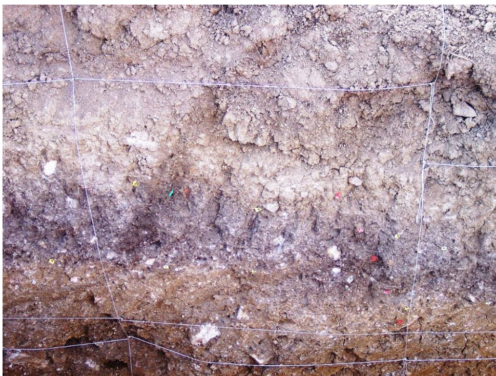
Εικόνα 4.6.3.9. Λεπτομέρεια του δυτικού τοιχώματος της τομής όπου στην οροφή φαίνεται η λεπτόκοκκη άμμος με διάσπαρτες κροκάλες και η άμμος χρώματος καφέ έως και άσπρη μέτριας κοκκομετρίας (κολλουβιακή σφήνα).
