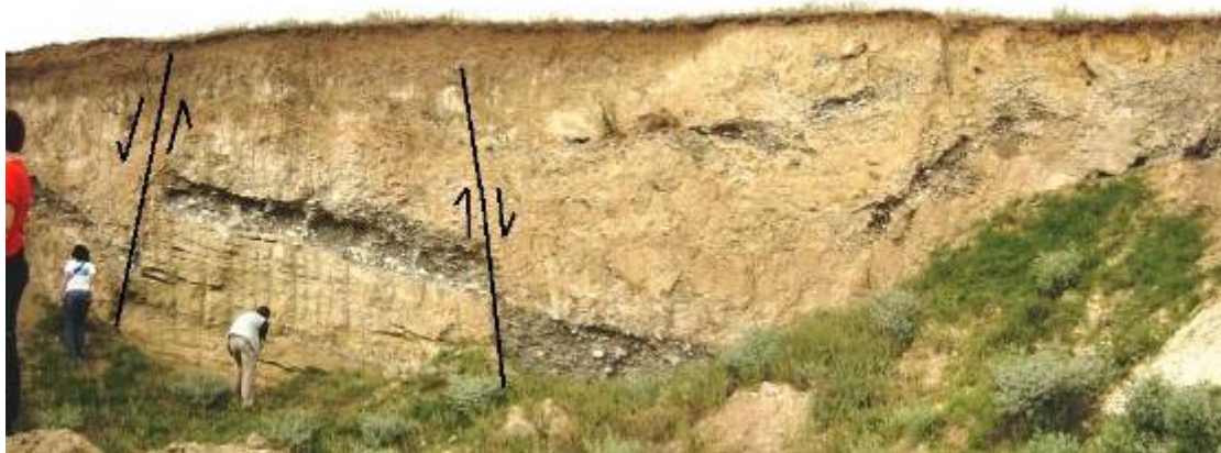
Σχ.4.2.3.4 Εμφάνιση του ρήγματος των Σερβίων σε χώρο αμμοληψίας έξω από το χωριό Ρύμνιο. Διακρίνονται οι κανονικές ρηξιγενείς δομές
