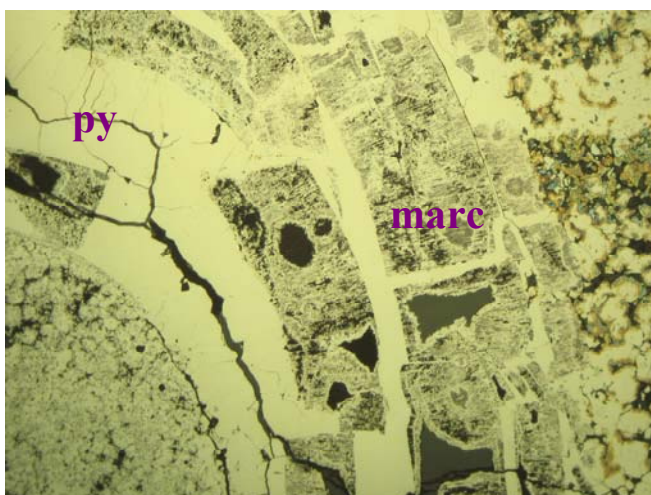
Εικ. 3.5.4. Ζωνώδης ανάπτυξη σιδηροπυρίτη (py) και μαρκασίτη (marc). Στιλπνή τομή, μεταλλογραφικό μικροσκόπιο, //N, μήκος φωτογραφίας 0,65 mm.
