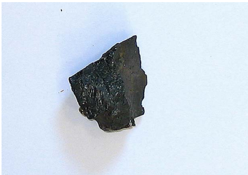
Εικ. 3.4.1. Μακροσκοπική φωτογραφία μεταλλεύματος μαγνητίτη-αιματίτη. Δείγμα: AA005.
