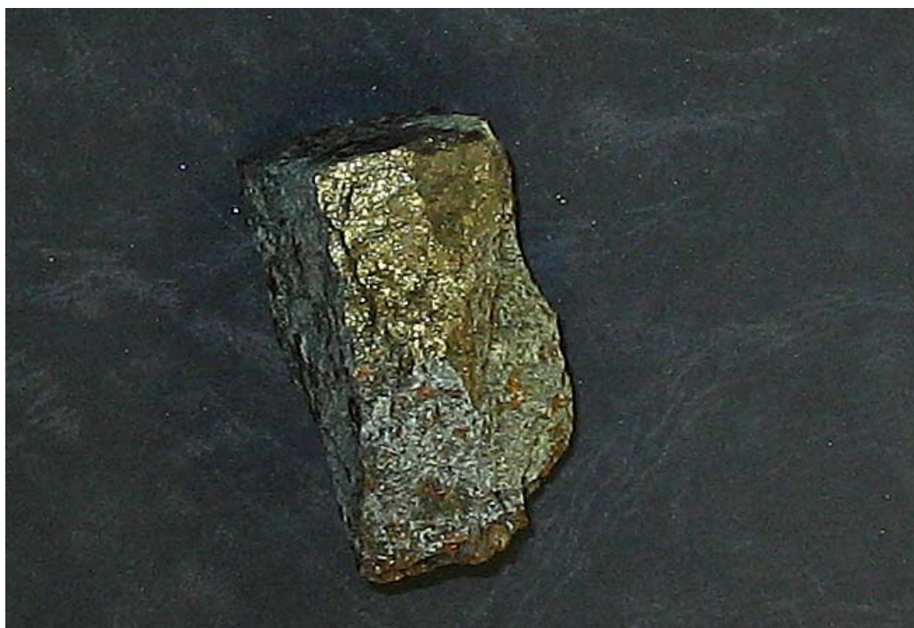
Εικ.. 3.11.1. Μακροσκοπική φωτογραφία μεταλλεύματος χαλκοπυρίτη. Δείγμα: AA169
