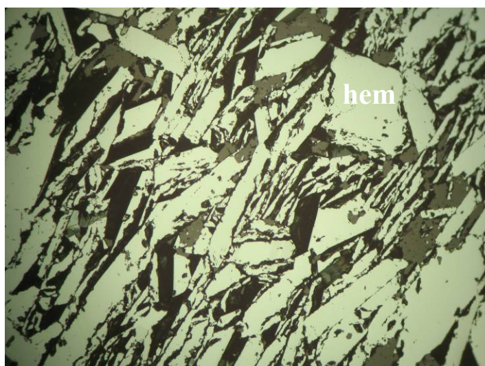
Εικ. 3.4.4. Κόκκοι και ελάσματα αιματίτη. Στιλπνή τομή, μεταλλογραφικό μικροσκόπιο, //N, μήκος φωτογραφίας 0,65 mm.
