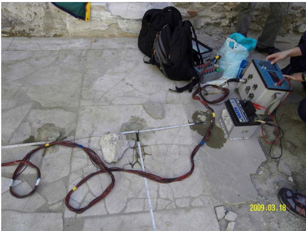
Εικόνα 3.4.2 Το όργανο και ο εξοπλισμός που χρησιμοποιήθηκαν, φαίνονται και τα ηλεκτρόδια επαφής με το μίγμα μπεντονίτη.
