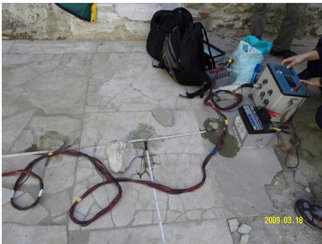
Εικόνα 2.6.1 Πολύκλιωνα καλώδια-ηλεκτρόδια επαφής και όργανο μέτρησης
