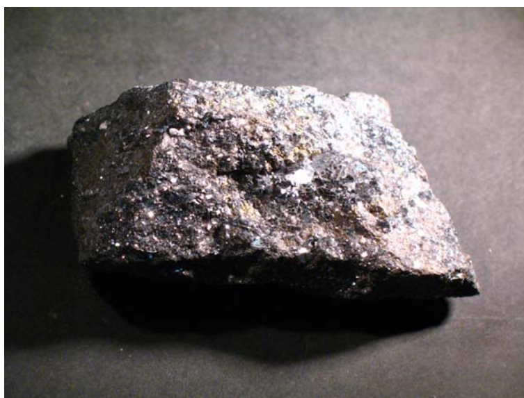
Εικ. 3.10.1. Μακροσκοπική φωτογραφία μεταλλεύματος βραουνίτη, πυρολουσίτη. Δείγμα: 7.5.1.3.1 (AZ 174). Μήκος φωτογραφίας: 10 cm.
