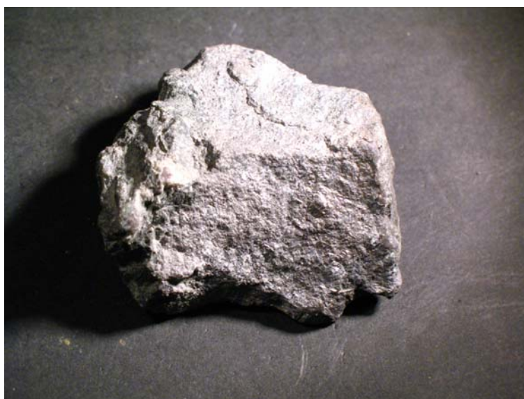
Εικ. 3.3.1. Μακροσκοπική φωτογραφία μεταλλεύματος συμπαγούς σιδηροπυρίτη-αρσеноπυρίτη. Δείγμα: 2.12.4.1.1 (AZ43). Μήκος φωτογραφίας: 10 cm.
