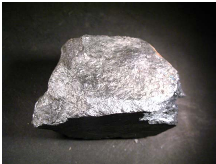
Εικ. 3.2.1. Μακροσκοπική φωτογραφία μεταλλεύματος κυρίως με βουρνονίτη (δείγμα 3.4.3.2 (AZ 26). Μήκος φωτογραφίας: 10 cm.
