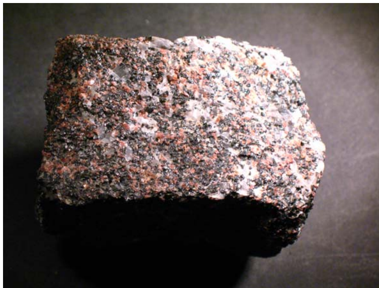
Εικ. 3.8.1. Μακροσκοπική φωτογραφία μεταλλεύματος μαγνητίτη. Δείγμα: 7.2.2.3.7 (AZ 110). Μήκος φωτογραφίας: 10 cm.
