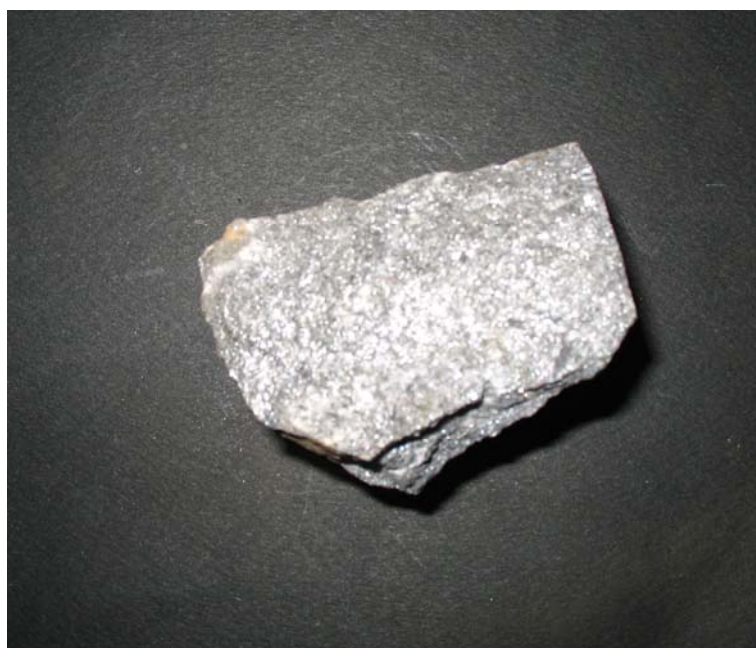
Εικ. 3.5.1. Μακροσκοπική φωτογραφία μεταλλεύματος βουρνονίτη. Δείγμα: 3.4.3.2.1 (AZ 65). Μήκος φωτογραφίας: 10 cm.
