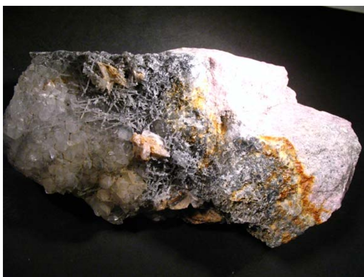
Εικ. 3.7.1. Μακροσκοπική φωτογραφία μεταλλεύματος βουλανζερίτη. Δείγμα: 3.4.3.2.3 (AZ 76). Μήκος φωτογραφίας: 10 cm.
