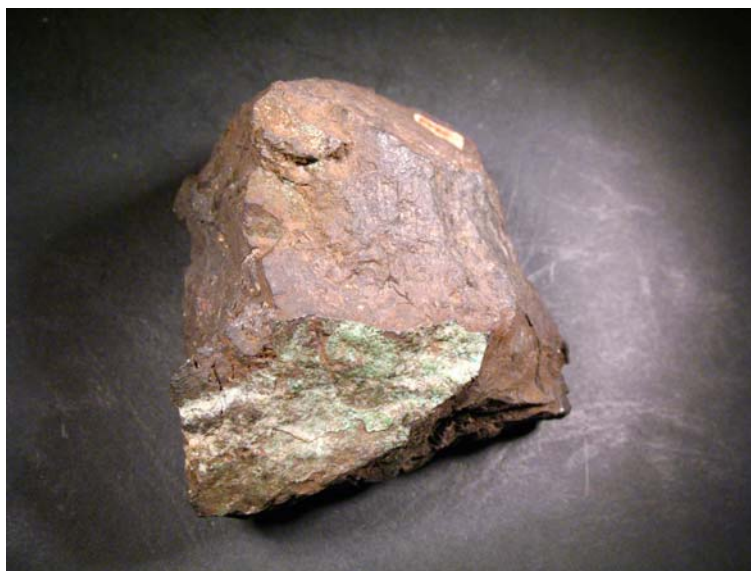
Εικ. 3.1.1. Μακροσκοπική φωτογραφία μεταλλεύματος κυρίως χαλκοσίνη (δείγμα 2.4.7.1 AZ 19). Μήκος φωτογραφίας: 10 cm.
