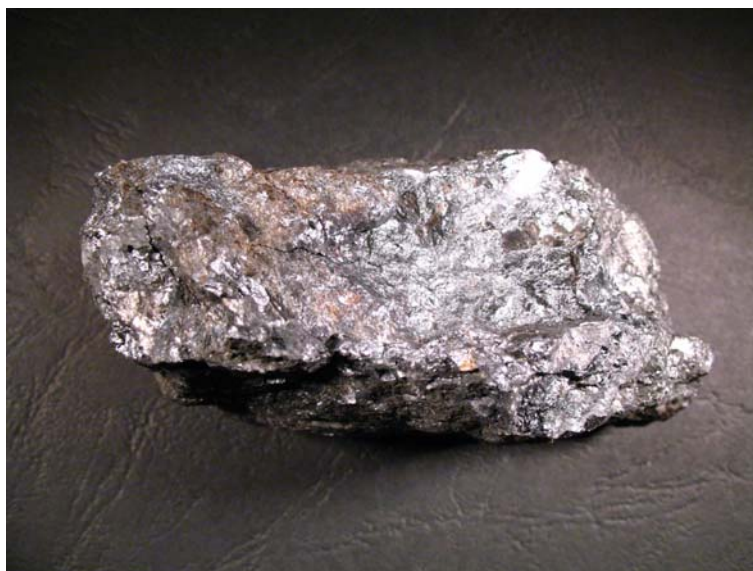
Εικ. 3.6.1. Μακροσκοπική φωτογραφία του μεταλλεύματος βουρνονίτη. Δείγμα: 3.4.3.2 (AZ 69). Μήκος φωτογραφίας: 10 cm.
