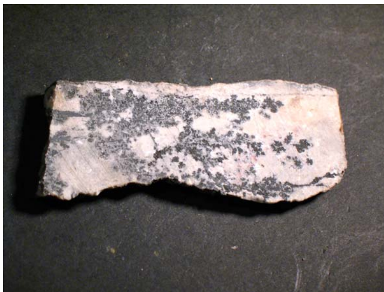
Εικ. 3.4.1. Μακροσκοπική φωτογραφία μεταλλεύματος κοβαλτίνη. Δείγμα: 1.1.1.2.1 (AZ 60). Μήκος φωτογραφίας: 10 cm.
