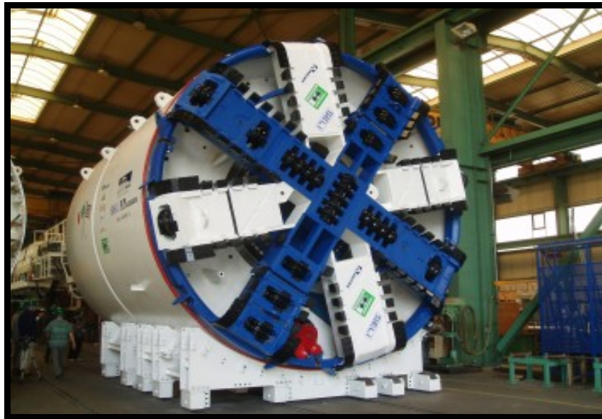
Εικόνα 23: Μηχάνημα Ολομέτωπης Διάνοιξης Σηράγγων με Ασπίδα Εξισορρόπησης της Πίεσης Εδάφους – EPB (Earth Pressure Balance)( http://www.ametro.gr )
