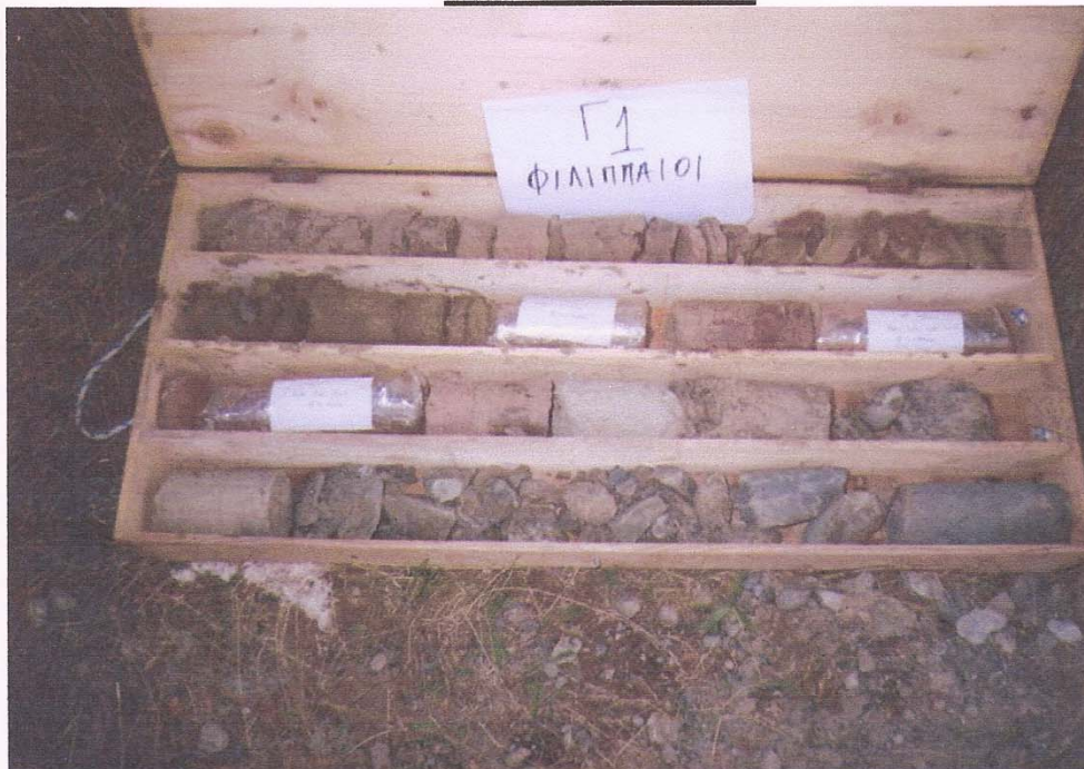
Φωτ. 1. Τα συλλεχθέντα δοκίμια, Προτύπου Διεισδύσεως και Φραγμού, από το βάθος των 0,00 έως 4,00 m της ερευνητικής γεώτρησης (Γ-1), στα πλαίσια του έργου "Ερευνητικές – δειγματοληπτικές γεωτρήσεις στην είσοδο του οικισμού Φιλιππαίων".
