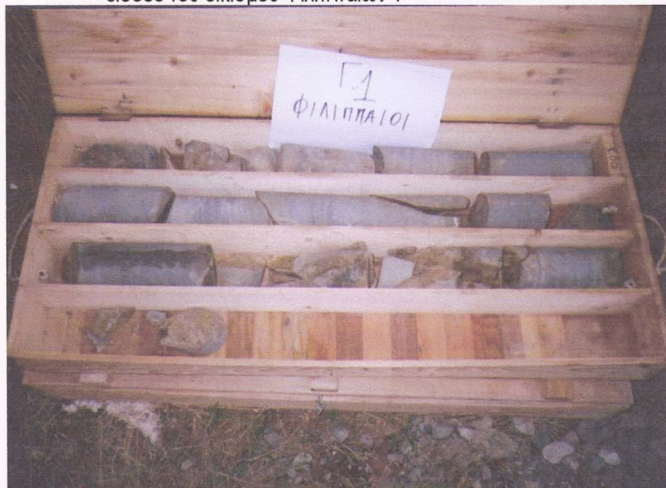
Φωτ. 2. Τα συλλεχθέντα δοκίμια, Προτύπου Διεισδύσεως και Φραγμού, από το βάθος των 4,00 έως 7,50 m της ερευνητικής γεώτρησης (Γ-1), στα πλαίσια του έργου "Ερευνητικές – δειγματοληπτικές γεωτρήσεις στην είσοδο του οικισμού Φιλιππαίων".
