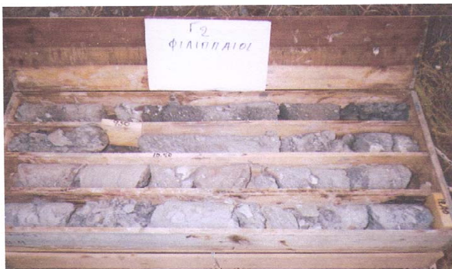
Φωτ. 3. Τα συλλεχθέντα δοκίμια, Προτύπου Διεισδύσεως και Φραγμού, από το βάθος των 8,50 έως 13,00 m της ερευνητικής γεώτρησης (Γ-2), στα πλαίσια του έργου "Ερευνητικές – δειγματοληπτικές γεωτρήσεις στην είσοδο του οικισμού Φιλιππαίων".
