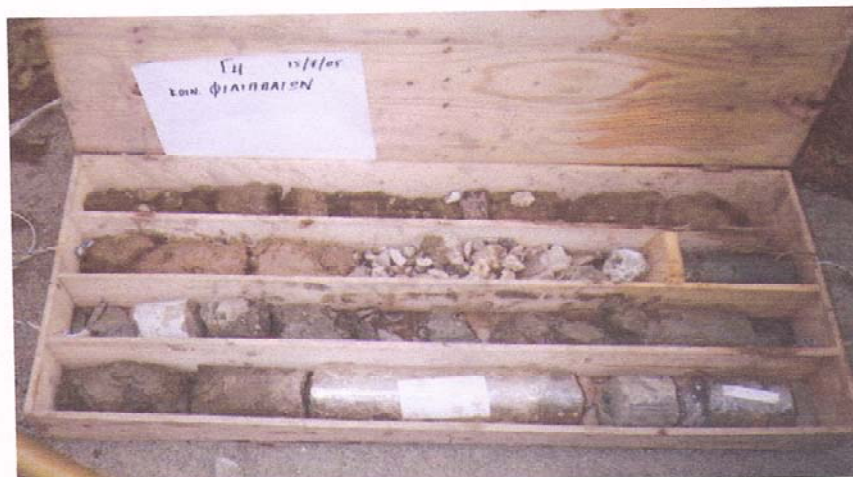
Φωτ. 1. Τα συλλεχθέντα δοκίμια, Προτύπου Διεισδύσεως και Φραγμού, από το βάθος των 0,00 έως 5,00 m της ερευνητικής γεώτρησης (Γ-4), στα πλαίσια του έργου "Ερευνητικές – δειγματοληπτικές γεωτρήσεις στην είσοδο του οικισμού Φιλιππαίων".
