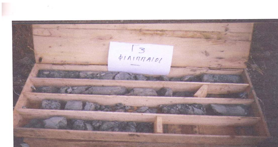
Φωτ. 3. Τα συλλεχθέντα δοκίμια, Προτύπου Διεισδύσεως και Φραγμού, από το βάθος των 8,50 έως 12,00 m της ερευνητικής γεώτρησης (Γ-3), στα πλαίσια του έργου "Ερευνητικές – δειγματοληπτικές γεωτρήσεις στην είσοδο του οικισμού Φιλιππαίων".
