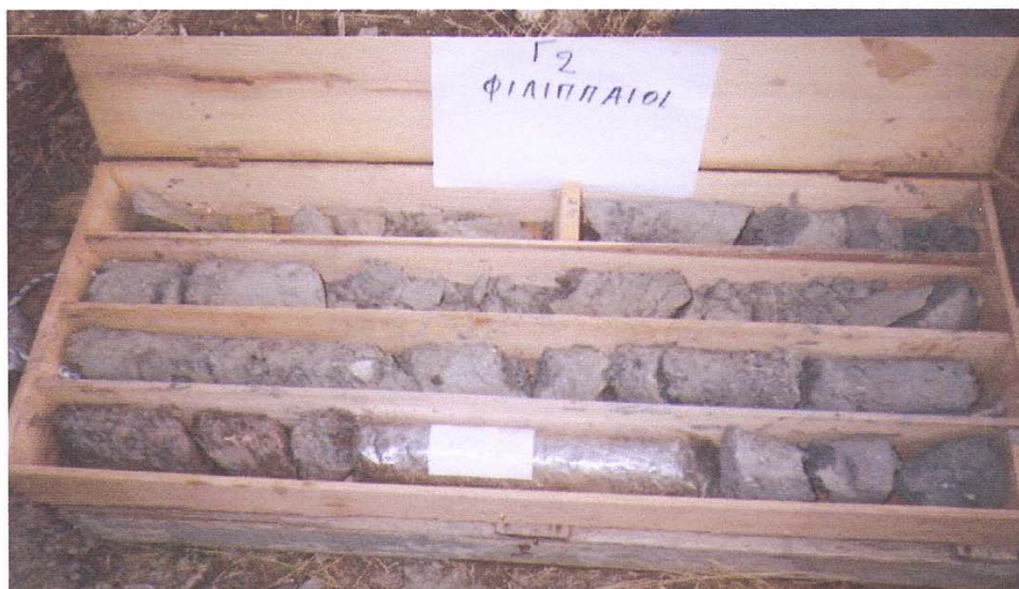
Φωτ. 2. Τα συλλεχθέντα δοκίμια, Προτύπου Διεισδύσεως και Φραγμού, από το βάθος των 4,00 έως 8,50 m της ερευνητικής γεώτρησης (Γ-2), στα πλαίσια του έργου "Ερευνητικές – δειγματοληπτικές γεωτρήσεις στην είσοδο του οικισμού Φιλιππαίων".
