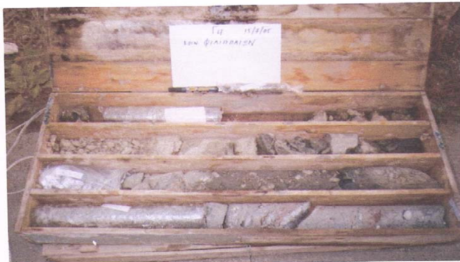
Φωτ. 2. Τα συλλεχθέντα δοκίμια, Προτύπου Διεισδύσεως και Φραγμού, από το βάθος των 5,00 έως 10,50 m της ερευνητικής γεώτρησης (Γ-4), στα πλαίσια του έργου "Ερευνητικές – δειγματοληπτικές γεωτρήσεις στην είσοδο του οικισμού Φιλιππαίων".
