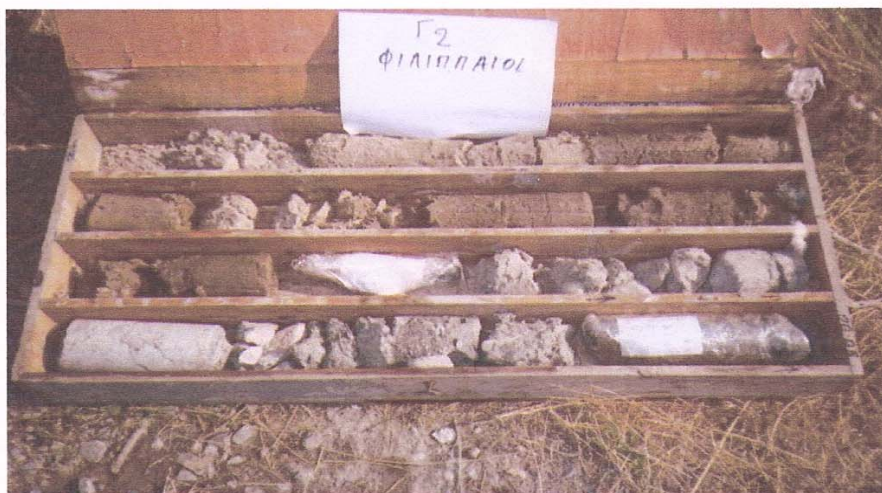
Φωτ. 1. Τα συλλεχθέντα δοκίμια, Προτύπου Διεισδύσεως και Φραγμού, από το βάθος των 0,00 έως 4,00 m της ερευνητικής γεώτρησης (Γ-2), στα πλαίσια του έργου "Ερευνητικές – δειγματοληπτικές γεωτρήσεις στην είσοδο του οικισμού Φιλιππαίων".
