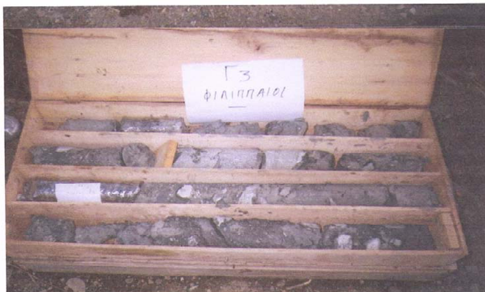
Φωτ. 2. Τα συλλεχθέντα δοκίμια, Προτύπου Διεισδύσεως και Φραγμού, από το βάθος των 4,00 έως 8,50 m της ερευνητικής γεώτρησης (Γ-3), στα πλαίσια του έργου "Ερευνητικές – δειγματοληπτικές γεωτρήσεις στην είσοδο του οικισμού Φιλιππαίων".
