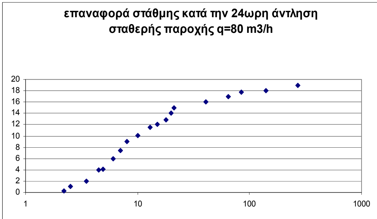
Σχήμα 26 Διάγραμμα επαναφοράς στάθμης κατά την 24ωρη άντληση με q = 80 \text{ m}^3/\text{h} στη γεώτρηση Γ3
