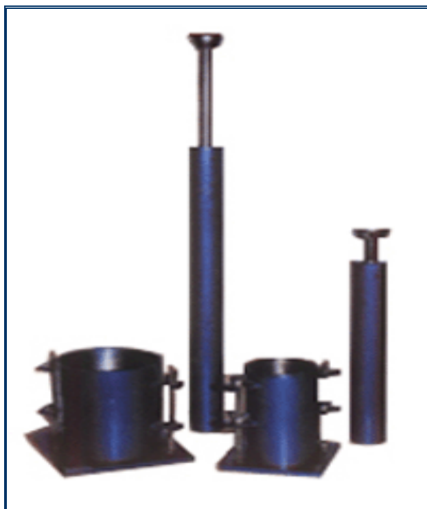
Σχήμα 6. Μήτρες και κόπανοι για την διεξαγωγή της δοκιμής Proctor και της τροποποιημένης δοκιμής Proctor.
