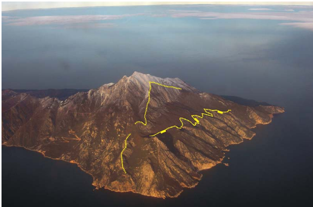
Σχ. 22. Αεροφωτογραφία του νοτίου τμήματος της χερσονήσου του Άθω, διακρίνονται οι τριγωνικές επιφάνειες του κανονικού ρήγματος μικρής γωνίας κλίσης και το κανονικό ρήγμα μικρής γωνίας κλίσης στη επαφή των πετρωμάτων της Μαγματικής Σειράς Χορτιάτη και των Τριαδικών μαρμάρων.
