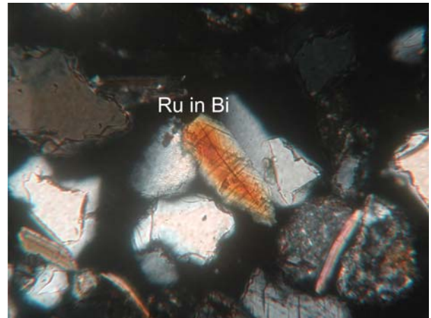
Φωτ. 7.2.2.7. Βιοτίτης (Bi). Στο εσωτερικό του εντοπίζεται ρουτιλίο (Ru) σε βελονοειδή μορφή (σαγενίτης). Το μήκος της φωτογραφίας είναι 1.2 mm. α: Πολωτικό μικροσκόπιο, N // β: Πολωτικό μικροσκόπιο, N
