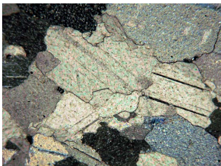
Εικ.7.4.2 Φωτογραφία μαρμάρου (Dion 4) σε πολωτικό μικροσκόπιο. Κόκκοι ασβεστίτη με πολυδυμίες και διαφορετικό μέγεθος, ετεροβλαστικός ιστός. +N, μήκος φωτογραφίας 1,3 mm.
