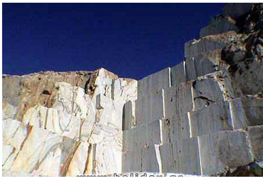
Εικ.5.11 Βαθμιδωτά μέτωπα εξόρυξης σε σύγχρονο λατομείο μαρμάρου στην Τήνο, σε θέση αρχαίας εκμετάλλευσης η οποία έχει καταστραφεί
