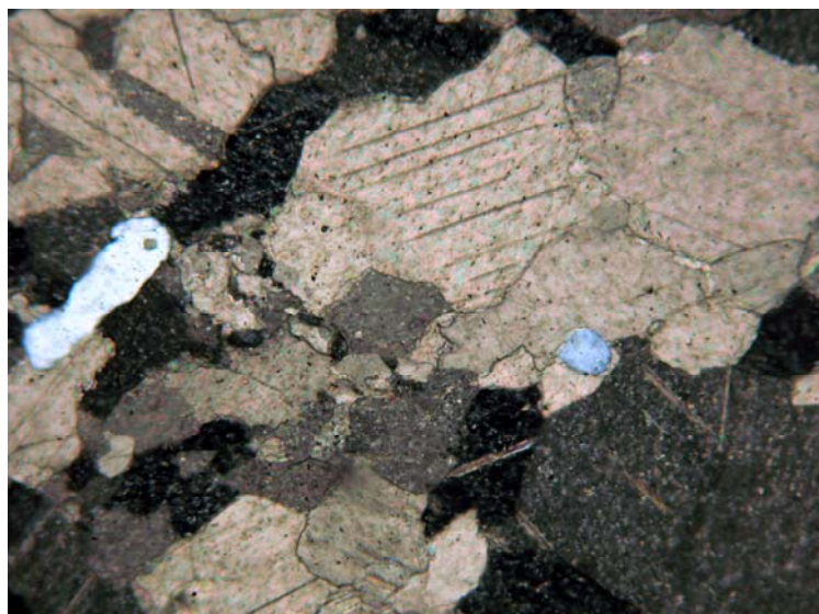
Εικ.7.5.2 Φωτογραφία μαρμάρου (Dion 5) σε πολωτικό μικροσκόπιο. Χαλαζίας (λευκό) και κόκκοι ασβεστίτη με πολυδυμίες και διαφορετικό μέγεθος, ετεροβλαστικός ιστός. +N, μήκος φωτογραφίας 1,3 mm.
