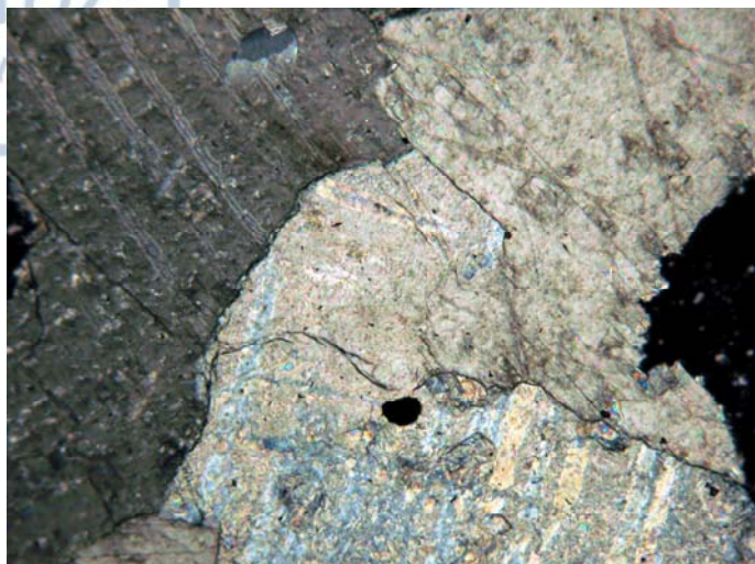
Εικ.7.9.2 Φωτογραφία μαρμάρου (Dion 9) σε πολωτικό μικροσκόπιο. Κόκκος χαλαζία (μαύρο στο κέντρο) και κόκκοι ασβεστίτη με πολυδυμίες και διαφορετικό μέγεθος, ετεροβλαστικός ιστός. +N, μήκος φωτογραφίας 1,3 mm.
