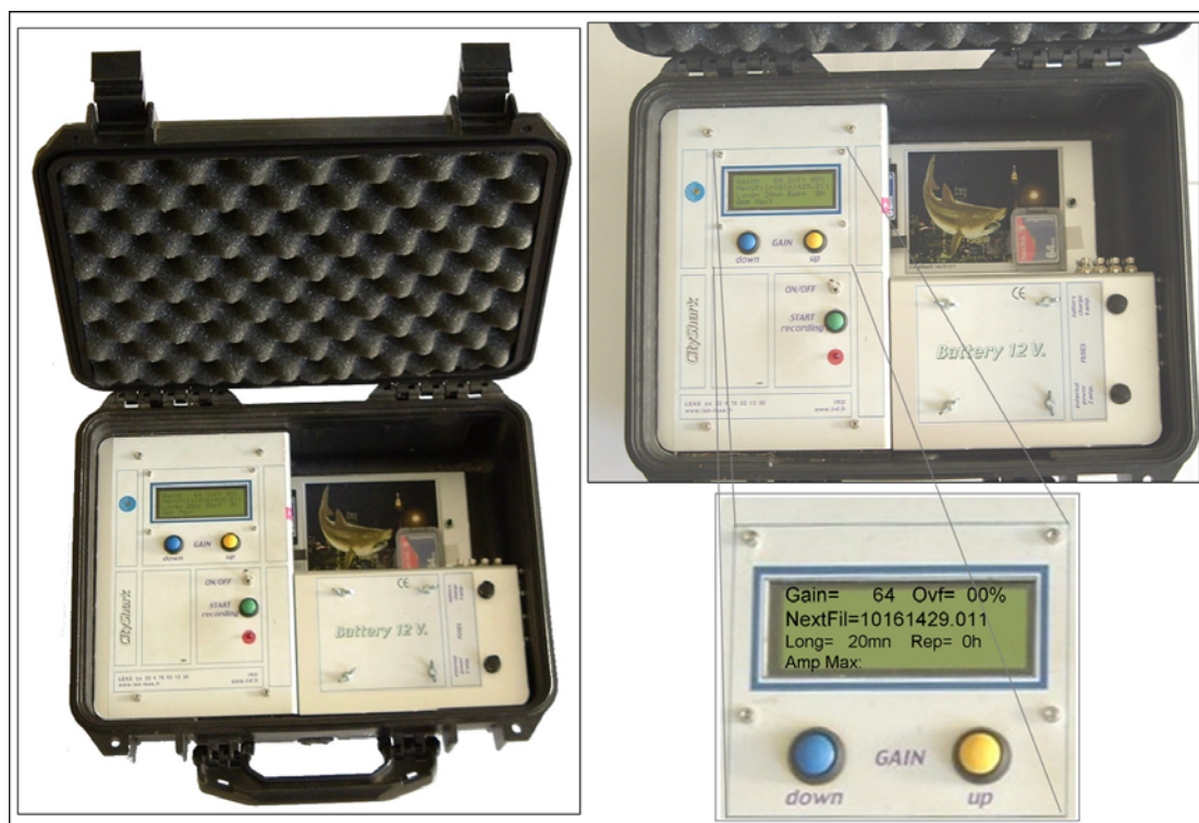
Σχήμα 11: Φωτογραφία του οργάνου CityShark I (αριστερό μέρος) όπου διακρίνεται η οθόνη και τα πλήκτρα εισαγωγής παραμέτρων (δεξί μέρος).
