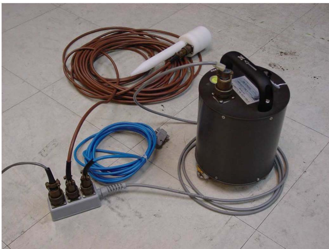
Σχήμα 51: Φωτογραφία του οργάνου Guralp CMG-6TD όπου εκτός από το σεισμόμετρο διακρίνεται η κεραία του GPS (με καφέ καλώδιο) και η συσκευή ( breakout box ) που επιτρέπει τη σύνδεση με εξωτερική μπαταρία (γκρι καλώδιο στο αριστερό μέρος της εικόνας), καθώς και με H/Y υπολογιστή (μπλε καλώδιο). Περισσότερες πληροφορίες μπορούν να βρεθούν στην ηλεκτρονική διεύθυνση www.guralp.com/products/6TD .
