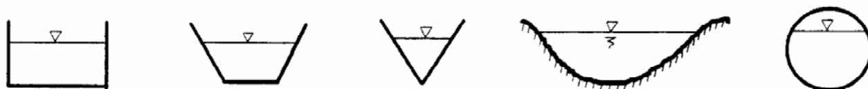
Σχήμα 4.3 Η διάκριση των τεχνητών αγωγών με βάση το σχήμα τους
