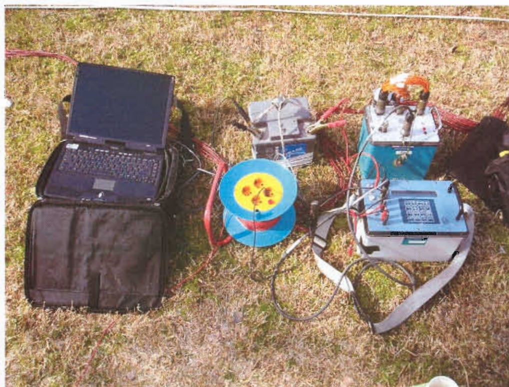
Εικ.7 - Εξοπλισμός που χρησιμοποιήθηκε στο ύπαιθρο με όργανο λήψης ηλεκτρικών μετρήσεων SYSCAL (V11.4++) της εταιρείας IRIS INSTRUMENTS.
