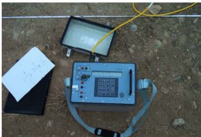
Εικ.3.3 Όργανο που χρησιμοποιείται στην μέθοδο της ειδικής ηλεκτρικής αντίστασης για την καταγραφή των λαμβανόμενων μετρήσεων.
