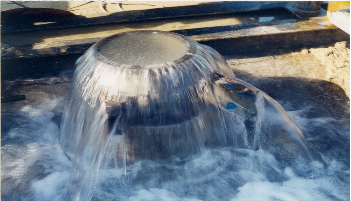
Φωτογραφία 1. Ο αρτεσιανισμός της γεώτρησης ΓΝ-1Π. Μπορούν να διακριθούν φυσαλίδες, λόγω έκλυσης αερίων.
